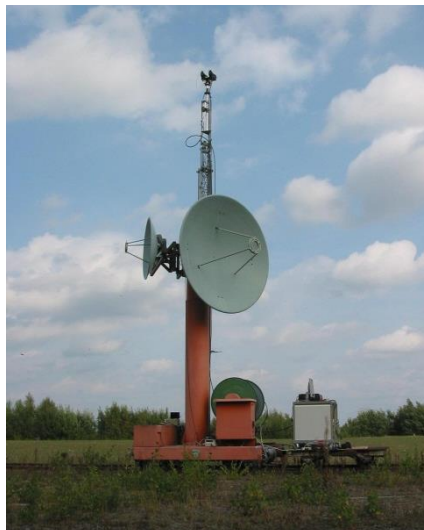
Figur 5. Antenn på mast monterad på rälsgående vagn på mätplatsen Lilla Gåra. Masten är ca 9.2 m hög.
