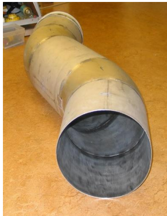
Figur 2. Olika vyer av kaviteten som använts för verifierande mätningar. Vänstra bilden visar kavitetens öppning; högra bilden visar den förslutna bakänden av kaviteten.
