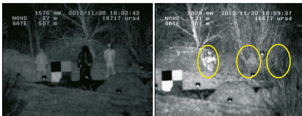
Figur 4-3. Mätning med GV i NIR (880 nm), avstånd 450 m. I vänster bild står personerna öppet och i höger bakom sly. Från vänster till höger i respektive bild: anorak och jeans, guillisuit, jaktkläder. Från vänster till höger i vänster bild: anorak och jeans, guillisuit, jaktkläder. Från vänster till höger i höger bild: jaktkläder, anorak och jeans samt guillisuit.
