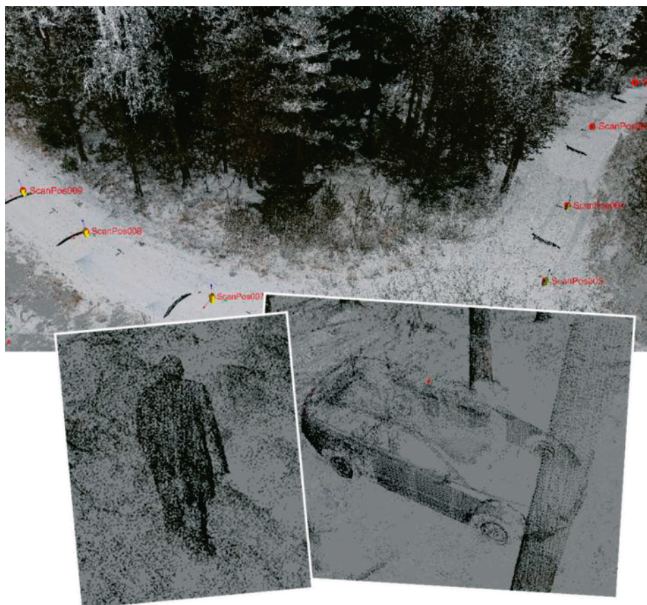
Figur 3-2. Punktmolnet överst visar modellen registrerad och färgtexturerad (det var snö). De gula punkterna visar var skanningen utfördes. Nedre raden visar skylddockan och bilen.
