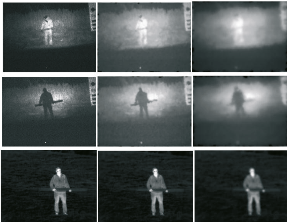
Figur 6-2. Exempel på simulerat turbulensinflytande för (från vänster till höger) låg, medel och hög turbulens utgående från upptagna GV-bilder samt IR-bilder (undre raden).
