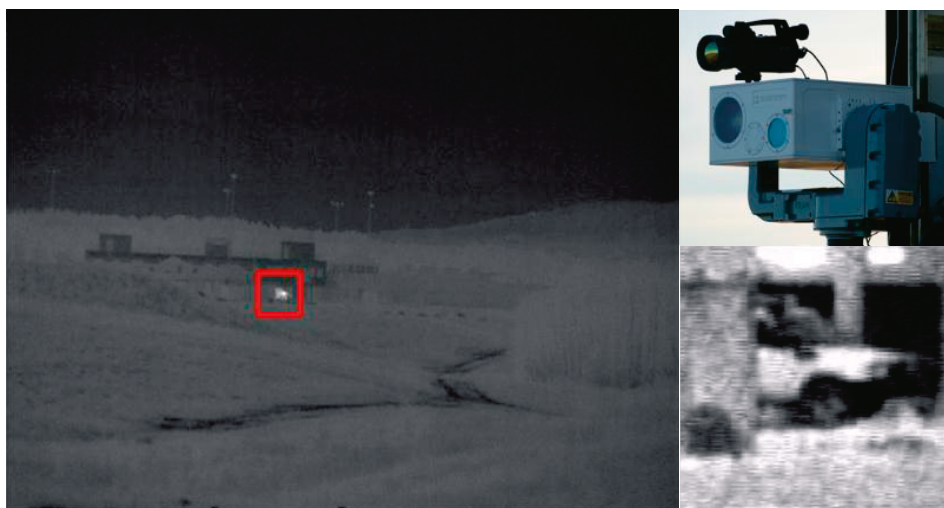
Figur 5-13. En bild från SIB-anläggningen vid MSS, Skövde. Fordonet detekteras och markeras i IR-bilden (vänster) och GV-kameran riktar in mot det området (höger, nedre). Höger, övre visar visar närbild på GV-kameran Obzerv med FLIR-kameran ThermaCAM SC660 monterad ovanpå.
