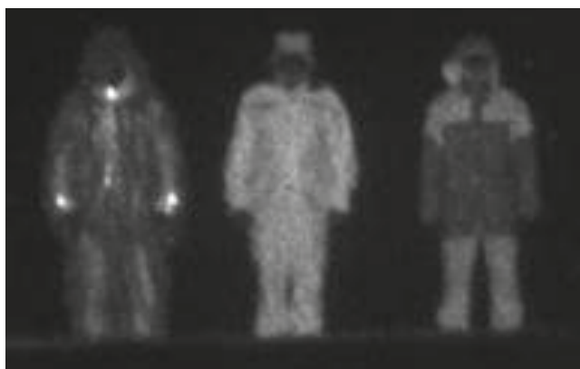
Figur 5-6. De tre personerna är våra mål. Mätning med MWIR i skymning, avstånd 600 m.
