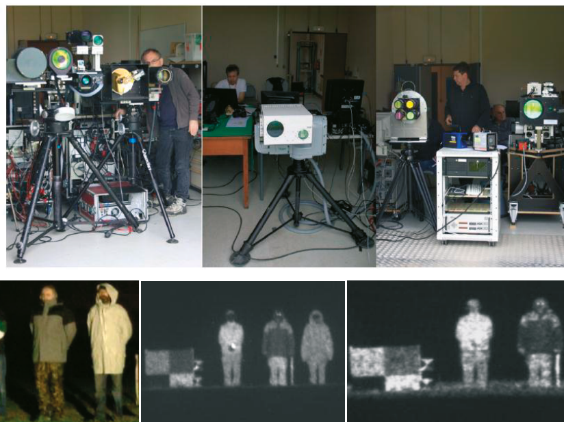
Figur 4-4. Övre raden: Sensorparken vid proven i Toulouse, våren 2013. Från vänster IOSB, FOI samt Onéras sensoruppställningar. Undre raden visar ett exempel på hur olika kläder kan te sig visuellt samt vid aktiv avbildning vid 1.55 μm (mitten) respektive 808 nm våglängd.
