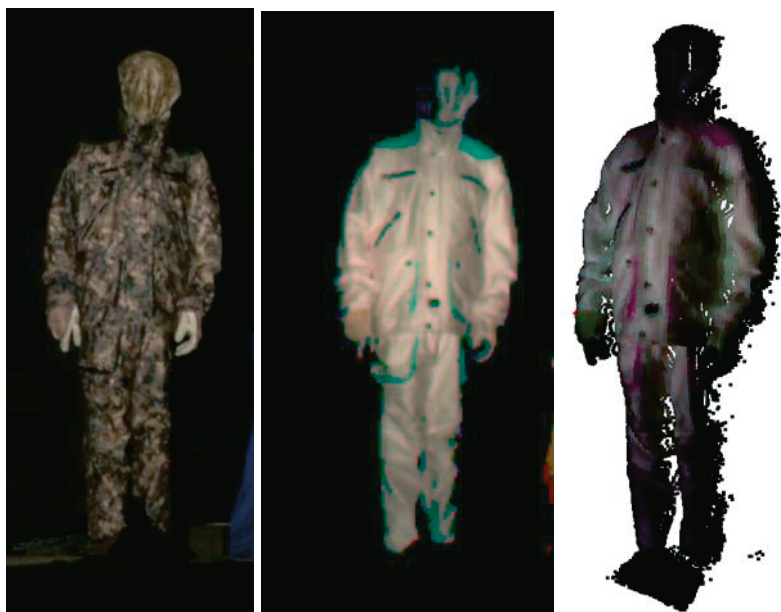
Figur 4-1. Mätningar kamouflagefärgade jaktkläder. Vänster visar visuellt foto på dockan med kläderna, mitten är en fusionsbild (detaljer av avvikande material/struktur syns väl; t ex förstärkningstyg på axlar och benficka, dragkedjor och knappar; kamouflagemönstret syns emellertid inte alls) samt höger är motsvarande fusionsbild som mitten, roterad i 3D (draperat punktmoln).
