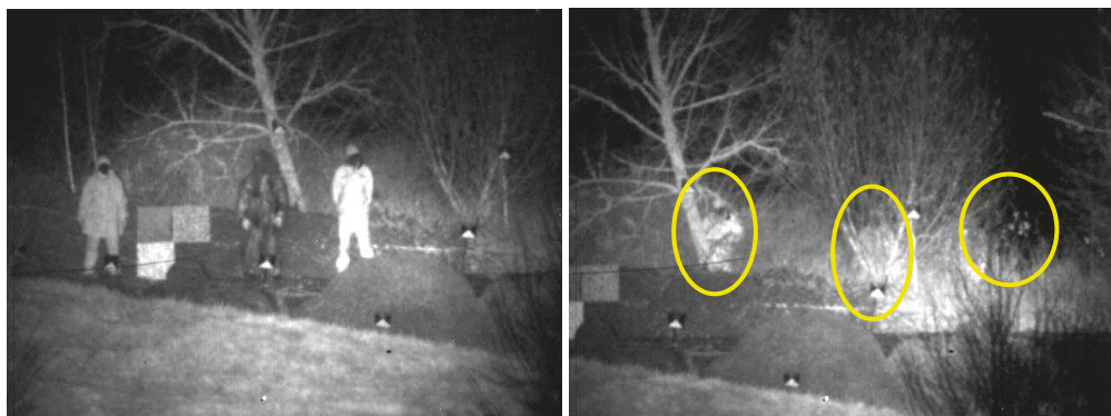
Figur 4-2. Mätning med GV i SWIR (1,55 \mu\text{m} ), avstånd 450 m. I vänster bild står personerna öppet och i höger bakom sly. Från vänster till höger i vänster bild: anorak och jeans, guillisuit, jaktkläder. Från vänster till höger i höger bild: jaktkläder, anorak och jeans samt guillisuit
