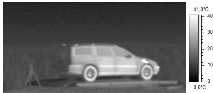
Figur 1. Uppmätt IR-bild av skenbar temperatur.
