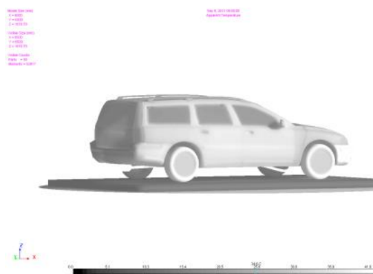
Figur 2. Beräknad skenbar temperatur utan BRDF.
