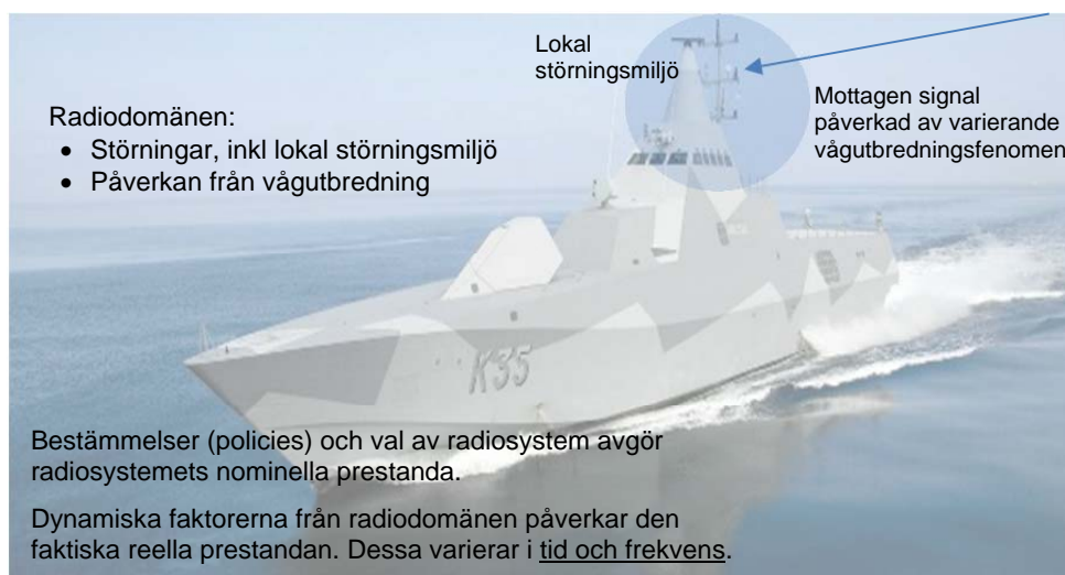
Figur 2. Illustration av de dynamiska faktorer som bör hanteras för att öka robustheten hos radiosystemen.
