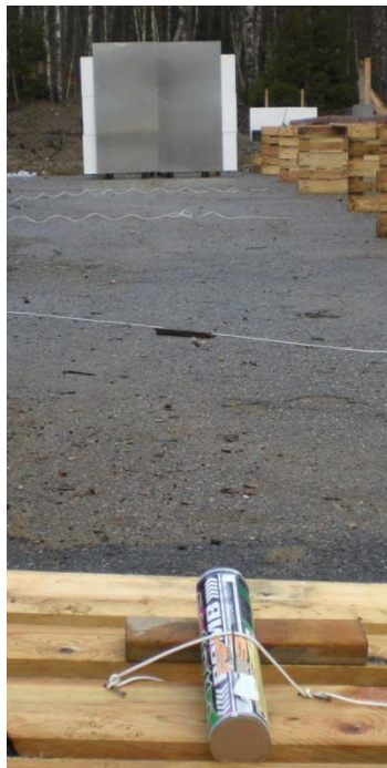
Figur 3. Försökupställning, fyrverkerieffekt mot aluminiumplåt.
