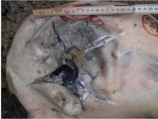
Figur 10. Skadeverkan av stjärn-/bombrör med 49 mm diameter, på 50 cm avstånd. Effekten fastnade i målet och exploderade där
