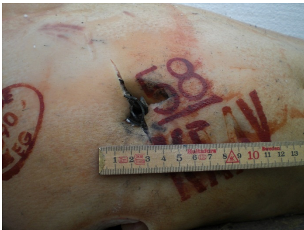
Figur 8. Sårskada av raket med en explosivämnesnettovikt på 38 g och en bruttovikt på 84 g. Penetration genom hud och vävnad med 5 cm. Raketen fastnade i grislåret.
