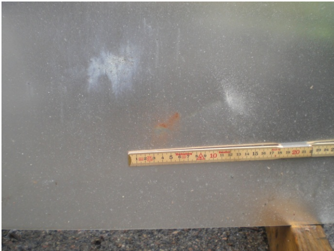
Figur 13. Resultat vid träff av stjärn-/bombkula med 36 mm diameter i 0,8 mm aluminiumplåt på 20 m avstånd. Otydlig träff i plåt, ingen skada.
