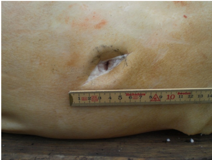
Figur 6. Sårskada av raket med en explosivämnesnettovikt på 48 g.
