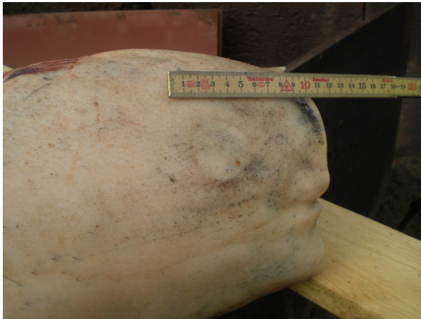
Figur 11. Försök med stjärn-/bombrör med 36 mm diameter, på 50 cm avstånd, visandes ingen penetration eller vävnadsskada på grislår efter träff.
