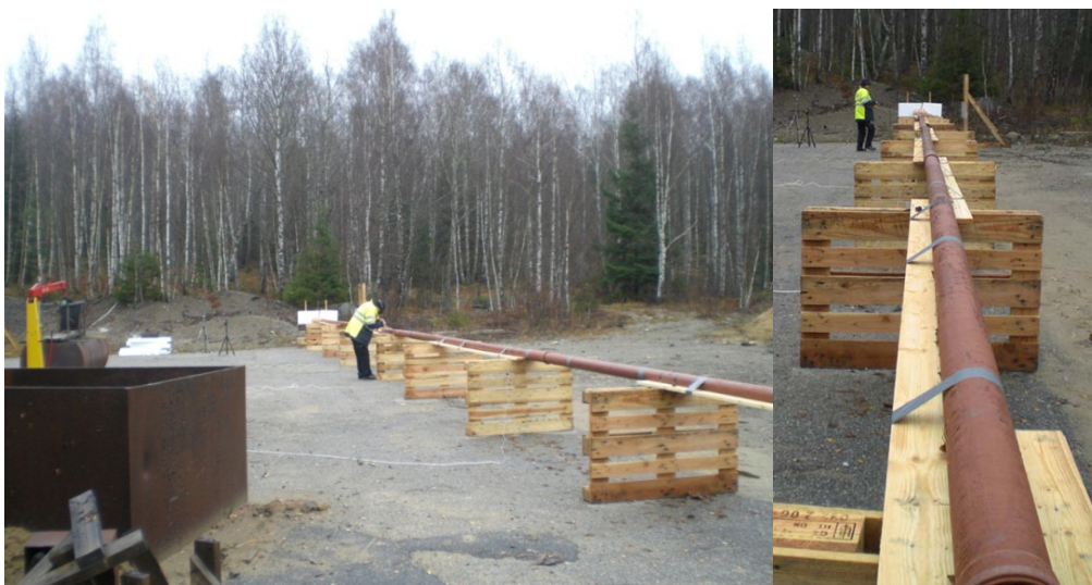
Figur 1. Försökuppställning för raketförsök i rörbana.
