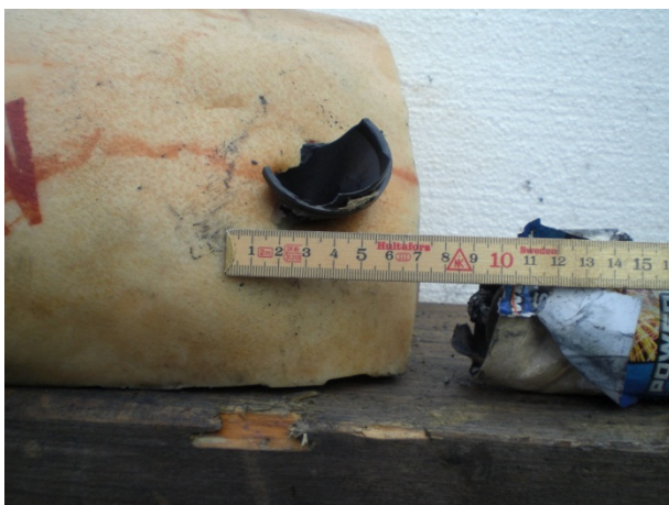
Figur 9. Sårskada av raket med en explosivämnesnettovikt på 71,6 g och en bruttovikt på 183 g.
