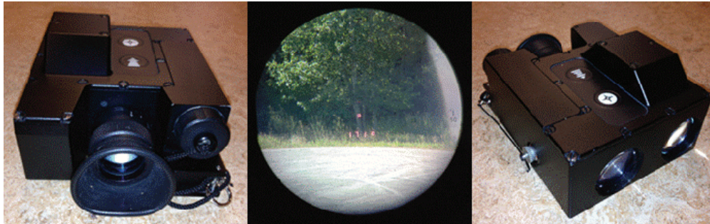
Figur 4. Till vänster, PLRF:ens okular som användaren tittar genom. I mitten bild från PLRF:ens okular i dagsljus med siffror som visar bäring till invisad position. Till höger, PLRF:ens öppningar för linserna som riktas mot objektet som ska mätas in.
