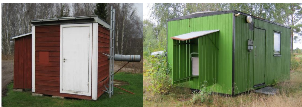
Figur 4. Insamlingsstationerna i Gävle (vänster) och Ljungbyhed (höger). Stationen i Gävle är så liten att nederbördstratten upptar större delen av takytan, stationsbyggnaden i Ljungbyhed är drygt dubbelt så stor.
