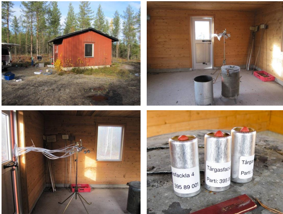
Figur 6. Tårgaskammare på SkyddC:s övningsområde. Inne i kammaren placerades åtta stycken filterhållare på ca 1,5 meters höjd. Tre tårgasacklor användes vid försöken. Bilder: Marianne Thunell.
