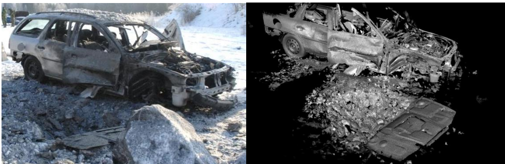
Figur 16. Forensisk geometrisk 3D-dokumentation av sprängd bil. Vänster bild är visuell och höger bild det avbildade punktmolnet i 3D. (Bilder FOI)
