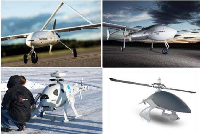
Figur 14. Unmanned sensors obemannade flygfarkoster, överst till vänster Discoverer I och till höger Discoverer II, nederst till vänster NEO S-350 VTOL och till höger ATRO-X VTOL UAV (bilder från Unmanned System Group)
