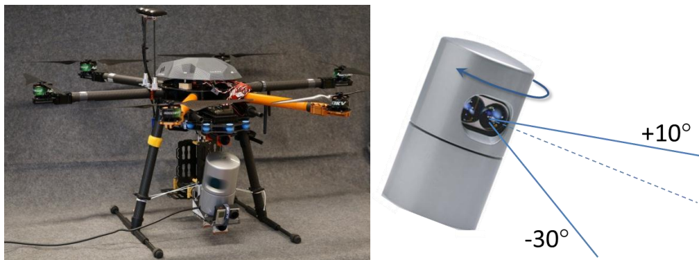
Figur 5. Laserskannern Velodyne HDL-32E väger endast 1.3 kg, är ca 1.5 dm 3 stor och skjuter 700.000 laserskott per sekund. Vänster bild visar skannern monterad i en hexakopter. Skannern roterar horisontellt runt sin egen axel (höger bild, blå pil) med mellan 300 och 1200 varv per minut. Synfältet är drygt 40° (+10 till -30). (Vänster bild FOI, höger bild Velodyne)
