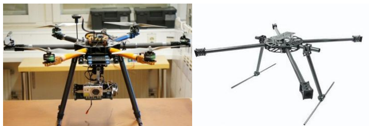
Figur 13. Multirotor klass 1B (nyttolast 2.3 kg) och multirotor klass 2 (nyttolast 5 kg).
