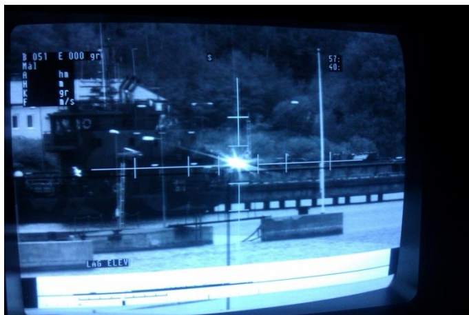
Figur 19. I ett fartygssikte syns en diodlaser riktad mot fartyget tydligt. I det här fallet är irradiansen så svag att bara en liten del av bilden bländas ut. Positionen kan bestämmas men den närmaste omgivningen till lasern är svår att se, och därmed är det svårt att identifiera om laserbelysningen utgör ett hot eller inte.
