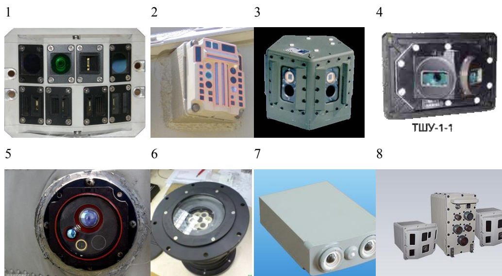
Figur 8. 1. Saab Avitronics, LWS 310 för fordon, flyg och fartyg, 2. Elbit, E-laws för fordon och fartyg, 3. Goodrich, 318s för fordon, 4. Zenit, TShU-1-1 för stridsfordon, 5. ATK (BAE), AN/AAR-47(v)2 kombinerad MAW och laservarnare för flyg, 6. Saab Avitronics laservarnare för ubåt, 7. OLO för flyg (SU-35), 8. Aselsan, LIAS för helikopter och flyg.
