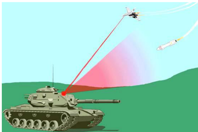
Figur 5. Principen för ett laserbelysarsystem. Målet belyses med en laser från ett flygplan och roboten som har avfyrats styr mot den reflekterade laserstrålningen.
