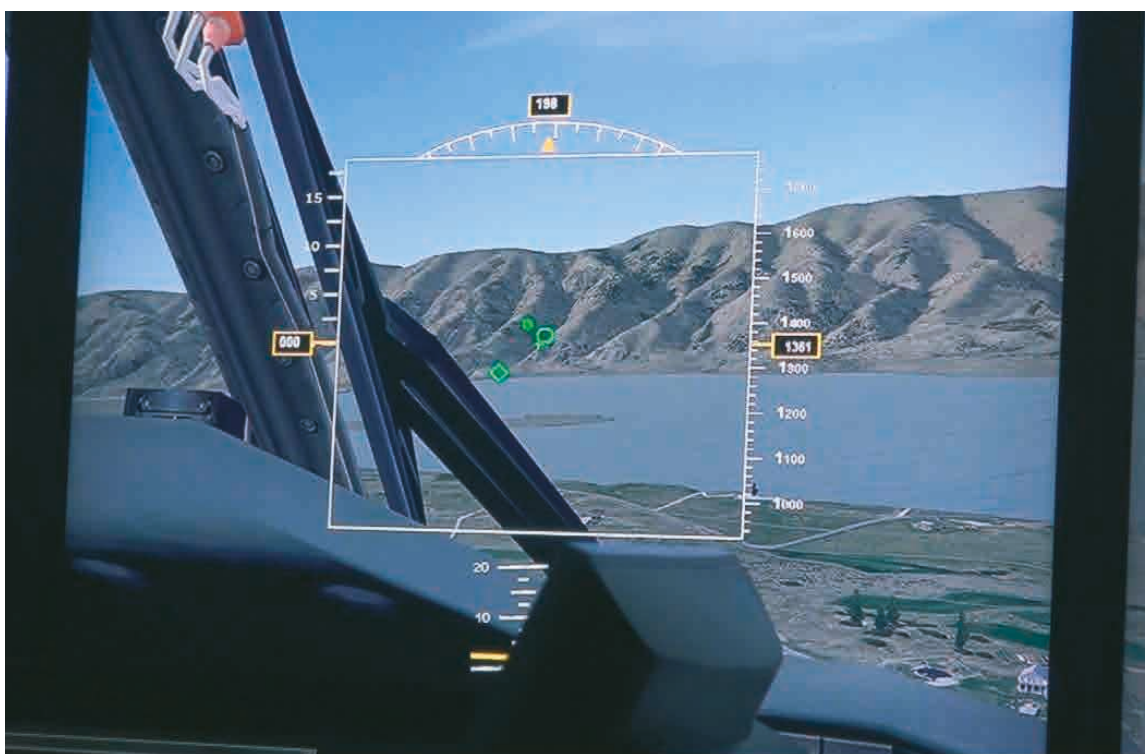
Figur 36. Driftdisplay med indikering av hur helikoptern driver (diamant), styrspakens position (fylld cirkel), var styrspaken bör placeras (icke-fylld cirkel) och mitten där symbolerna ska befinna sig för att uppnå hovring.
