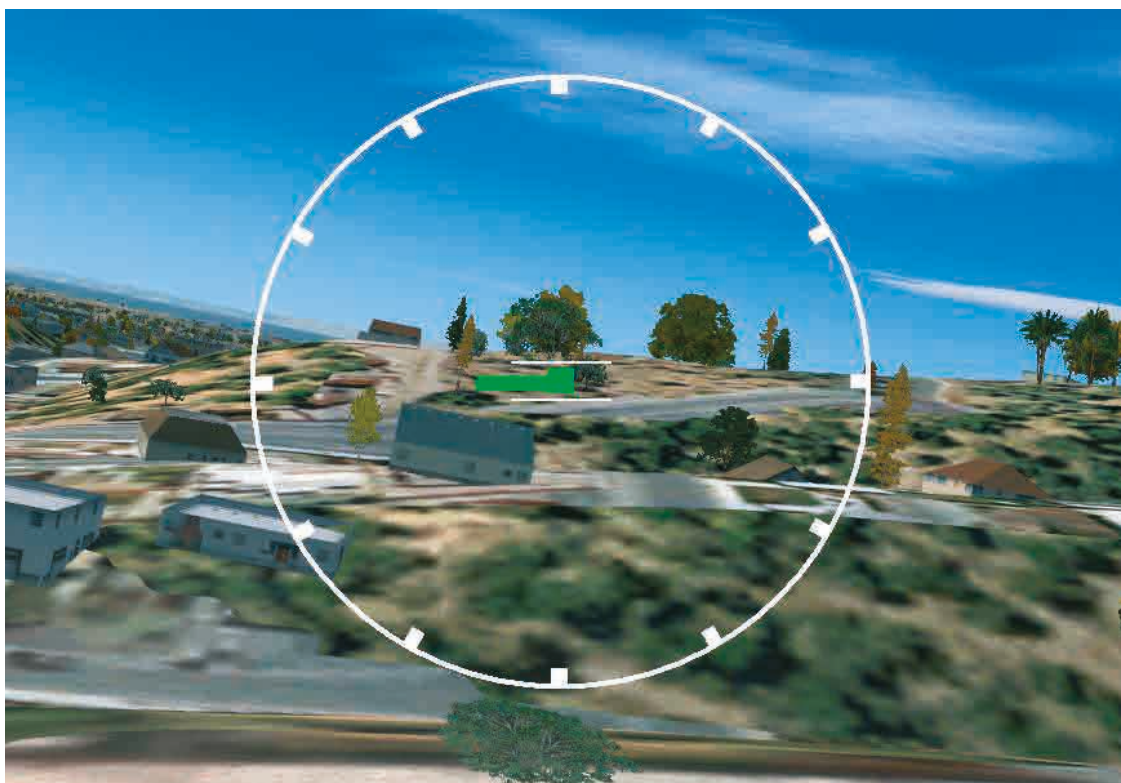
Figur 11. Visuell lateral display med den gröna linjen som indikerar drift till vänster.
