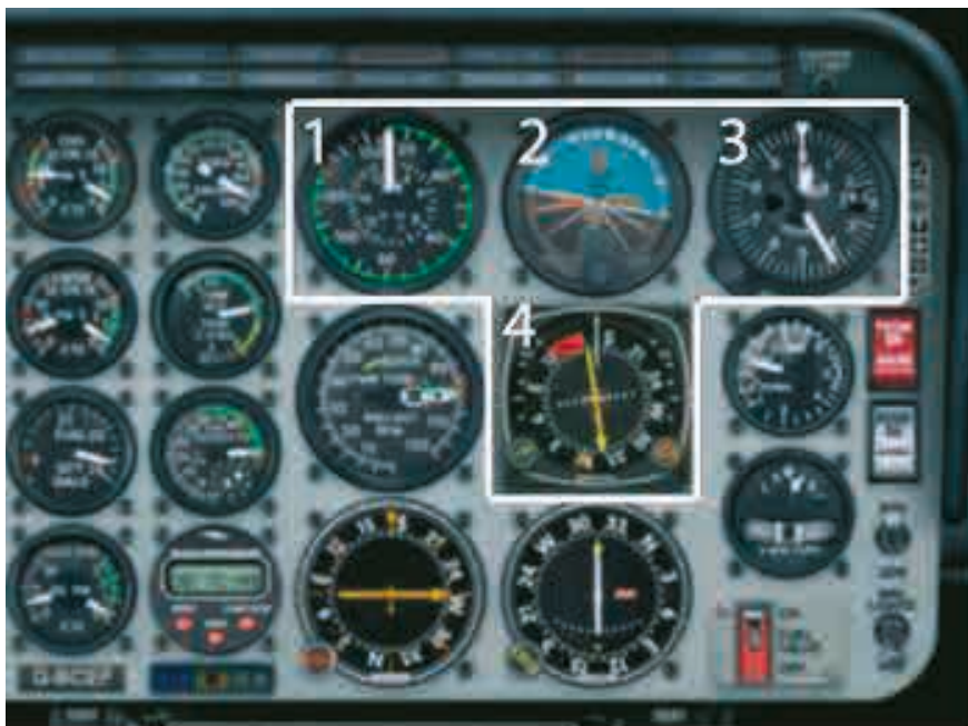
Figur 15. Standarddisplay med den svarta T-formade ramen som benämns "Basic T" med (1) hastighetsmätaren (vänster), (2) horisontgyro (mitten), (3) höjdmätare (höger) och (4) kompass (nere i mitten).
