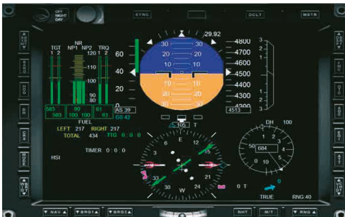
Figur 7. Den visuella standarddisplayen. Nederst i mitten kompassen, bokstaven E överst anger att helikoptern färdas österut.
