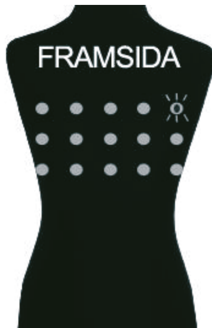
Figur 27. Illustration framifrån på en deltagare som bär den taktila driftdisplayen, som här indikerar drift snett uppåt till vänster (uppåt till höger i bild) genom att pulsering sker i displayens övre band till vänster.
