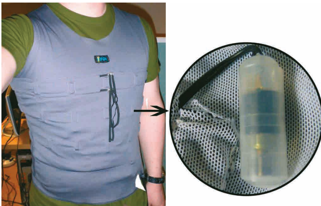
Figur 5. Väst med tre ringar, 12 taktorer i respektive ring ger sammanlagt 36 taktorer. Till höger visas en taktor (längd 27 mm) som normalt är insydd i västen.
