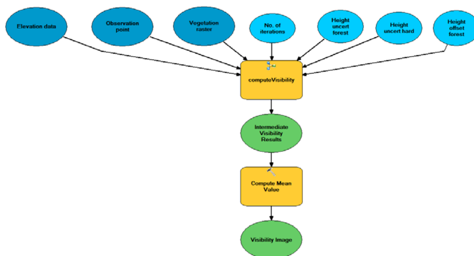
Figur 2. Algoritmen implementerades i Modelbuilder och har sju inparametrar: höjddata, observatörspositionen, vegetationskarta, antal iterationer, höjdosäkerhet i vegetationsområden respektive för öppna ytor, samt höjdoffset i vegetationsområden. Den här modellen använder i sin tur modellen computeVisibility (den övre gula rutan) som är den som genererar siktfältsberäkningarna (Figur 3).
