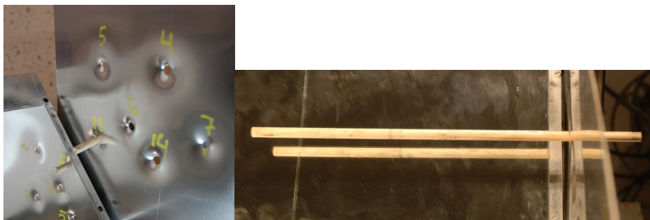
Figur 1. Genomslag av rundstav i 1 mm aluminiumplåt för två olika splittermassor. Rundstavarnas hastighet var nära gränshastigheten då de fastnade i målplåten.
