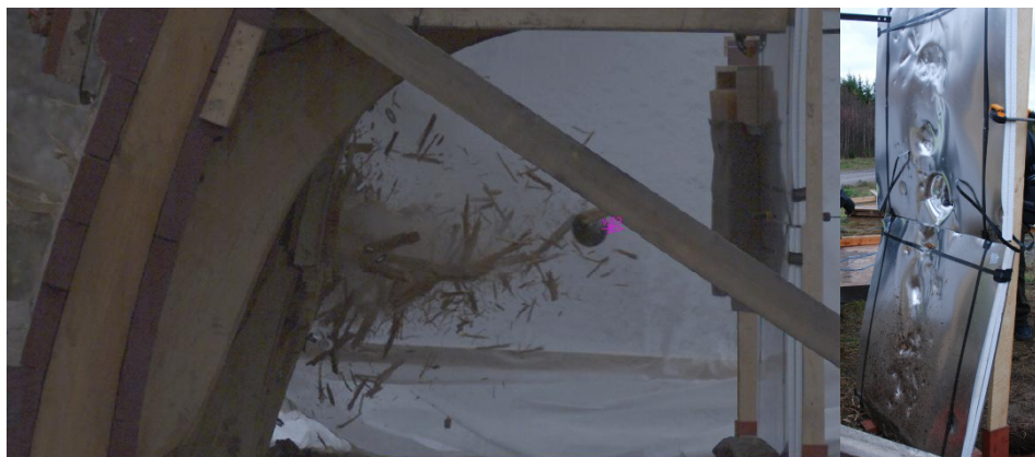
Figur 19. Bild från höghastighetsfilm av kanonkulans genomslag av skrovsidan med splitterkonens hastighet och utformning. Höghastighetsfilmning: BTC. Till höger splitterverkan på vittnespaketet bakom skrovsidan. Foto: Sofia Hedenstierna, FOI.
