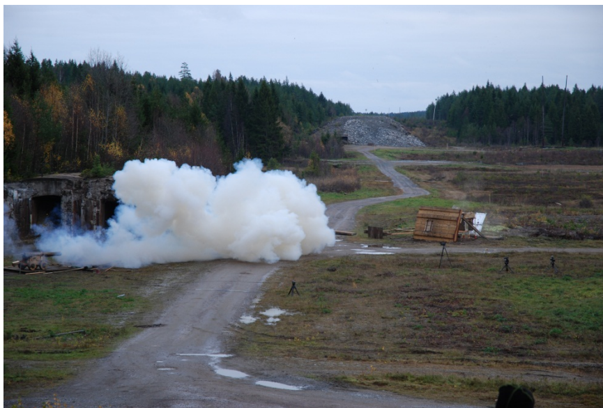
Figur 18. Första skottet från Vasakanonen mot en replik av skeppets skrovsida i ek med vittnespaket för splittrvärdering uppställda bakom. Foto: Sofia Hedenstierna, FOI.
