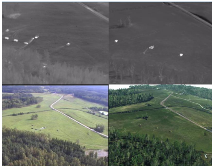
Figur 3-6. Mätdata och simulerad data från QWIP samt visuell sensor från Kvarn september 2004. Övre vänster: mätdata från QWIP, övre höger: simulerad QWIP, nedre vänster: mätdata från visuell kamera, nedre höger: simulerad visuell data.
