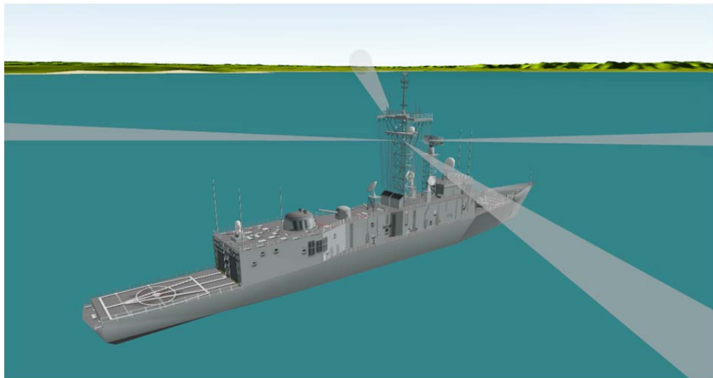
Figur 4: Fartyg med en multifunktionsgruppantennradar med fyra fasta antennaperturer. Synligt är fyra samtidiga spaningslober, en från varje antennapertur. Lobernas riktning ändras snabbt under en simulering. Bild från visualisering av en simulering med SIMDIS [18].
