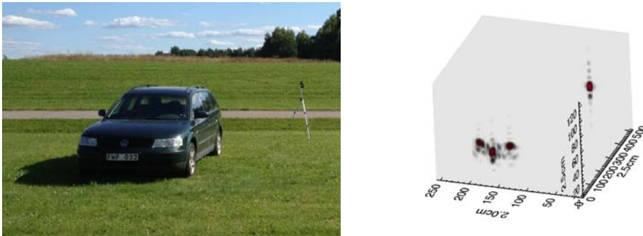
Figur 3: Målsken (vänster) och 3D-målsvar för scenen efter inkoherent sammanslagning av de fyra delaperturerna (höger). Storleken på kuberna i högra bilden är 12,5 m i avstånd, 5 m i sida och 3 m i höjd.
