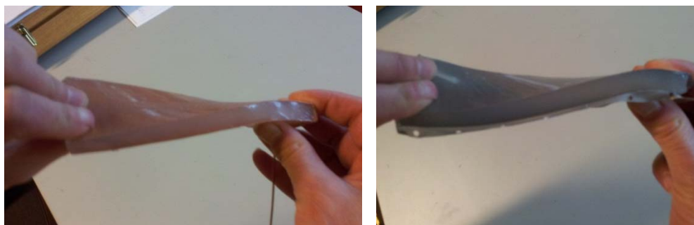
Figur 7: Antenn med ett kopparnät (vänster) och med ett tunt nät i rostfritt stål (höger). I båda fallen är dielektrikat av silikon.
