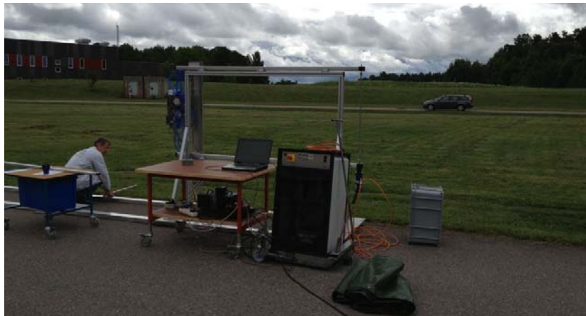
Figur 1: Mätupställning för 3D-SARmätningar med den utglesade gruppantennen.
