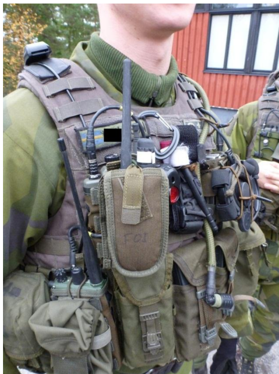
Figur 15 Soldat utrustad med GPS-sändare och mottagare. Mottagaren är placerade i en bärficka på soldatens stridsväst, sändaren är monterad på soldatens axel.
