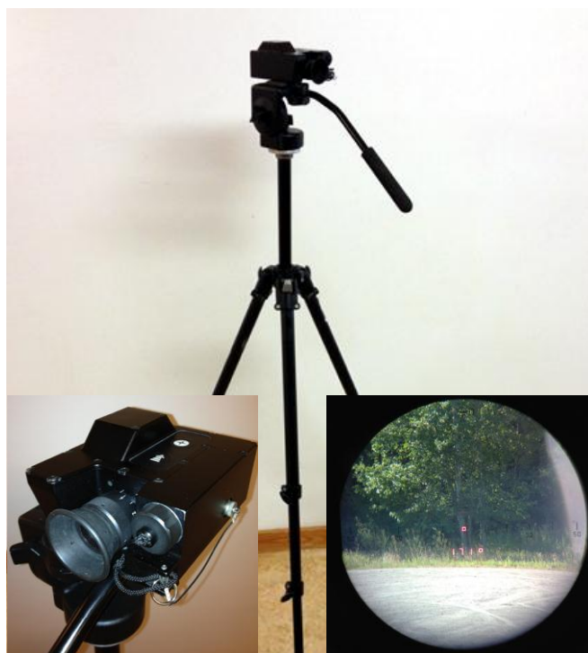
Figur 4. Överst bild på PLRF:en monterad på kamerastativ. Nederst till vänster bild på PLRF:ens framsida och till höger bild genom PLRF:ens okular som visar instrumentets kompassriktning i grader med röda siffror.
