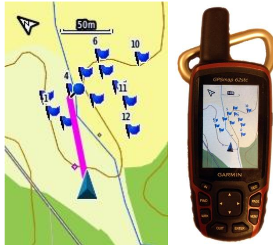
Figur 12. GPS:ens karta som visar egen position och målpositionerna som skulle pekats ut. Den violetta linjen från symbolen för egen position visar att position fyra skulle pekats ut och att dess position var några grader till vänster om deltagaren.
