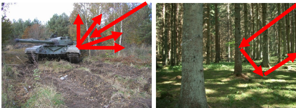
Figur 2-1. Schematisk illustration av radarreflektion från fordon respektive skog på VHF-bandet. Våglängden på det använda frekvensbandet (27-82 MHz) varierar inom intervallet 4-10 m. Infallande riktning för radarstrålningen illustreras av den långa pilen från det övre högra hörnet i bilderna. Vänstra bilden visar den reflekterade strålningen från ett fordon, dvs. som sprids inom en bred sektor eftersom fordonets utsträckning i höjddled är litet i förhållande till våglängden. I den högra bilden visas radarreflexen från skog som domineras av hörnreflektion mellan trädstammar och mark eftersom stammarna är höga i förhållande till våglängden, och marken kan betraktas som plan. Hörnreflektion mellan vertikal stam och horisontell mark ger starka radarekon som koncentreras till en small sektor i motsatt riktning i förhållande till den inkommande radarstrålningen.
