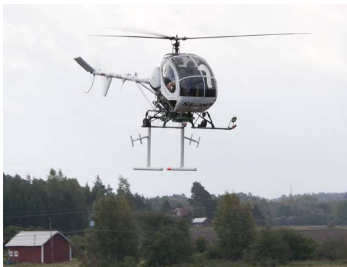
Figur 5-1. Saabs SAR-system CARABAS-3 installerat på helikopter Schweizer 300 tillhörande Malmskogens Aerocenter AB. Antennsystemet fälls ner av radaroperatören efter start och återförs i parkeringsläge inför landning. Den sistnämnda positionen intas även automatiskt i händelse av spänningsbortfall. De två horisontella antennelementen utnyttjas vid mätningar på det lägre frekvensbandet och kan programmeras att samverka så att radarbelysning och mottagning kan styras mot höger eller vänster sida om helikoptern. För det högre frekvensbandet finns identiska antennelement på båda stödbenen och val av sida görs i detta fall genom att operatören aktiverar aktuell antenn. (Foto: Saab / Stefan Kalm).
