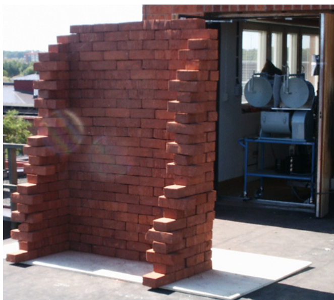
Figur 9. Bildalstrande mätning genom tegelvägg med avsökande antennsystem (från Nilsson m.fl., 2008).
