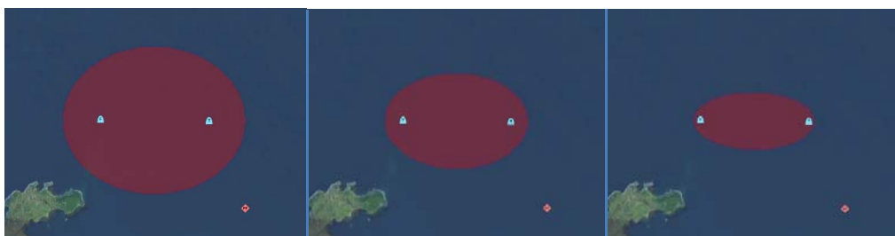
Figur 2. Täckningsdiagram för placering av radiostörsändare. De blå flygplanen använder sig av ett frekvenshoppande system för kommunikation och det röda fartyget har en följestörare. Det röda området i varje bild markerar var störaren ska vara placerad för att kunna störa kommunikation mellan de båda flygplanen. Från vänster till höger i bilderna sker frekvenshoppet med allt högre hopptakt.
