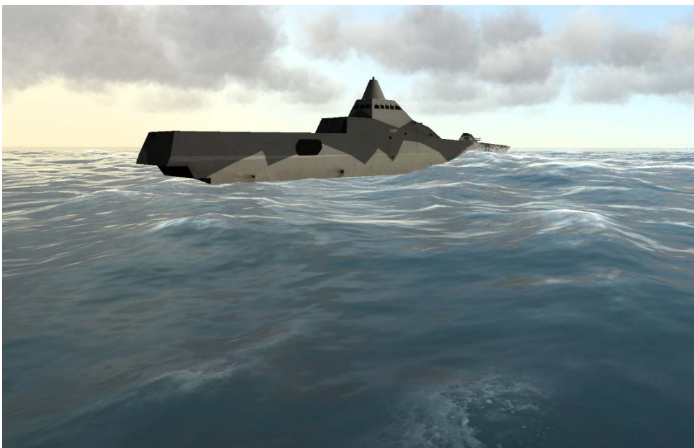
Figur 12. Bilden visar hur vågtoppar täcks av skum samt hur vågmodellen genererar en dynamisk 3D-geometri till skillnad från den tidigare platta havsvisualisering.
