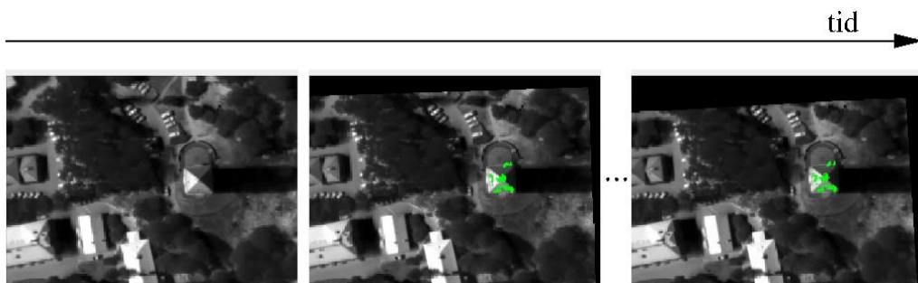
Figur 14. Parallaxrörelse. Sekvensen är stabiliserad mot på markplanet, men det höga tornet har en betydande residualrörelse även efter stabilisering.
