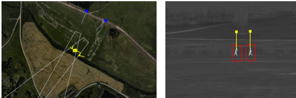
Figur 33. Vänster: Gemensam lägesbild där målspar och de egna spaningsfordonen visualiseras på en karta. Höger: Målspar och detektioner har överlagrats på sensordata.
