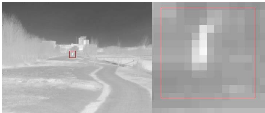
Figur 4. Detektion av människa på 250 meters avstånd. Målet är 6-7 pixlar högt.
