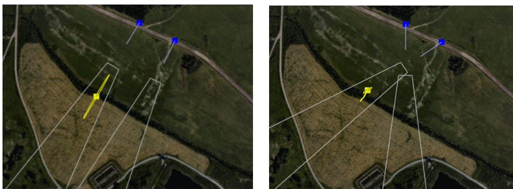
Figur 34. Vänster: Målspar med positionsosäkerhet när ett av målen har observerats av en sensor. Höger: Samma målspar med positionsosäkerhet efter det att målet även har observerats av den andra sensorn.
