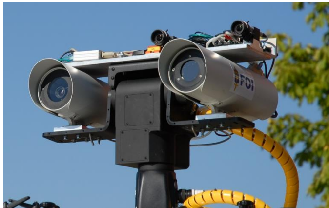
Figur 23. Illustration av det nya SLAM-systemet anpassat för utomhusbruk. Här monterat på ett vridbord tillsammans med en visuell och en IR-kamera.
