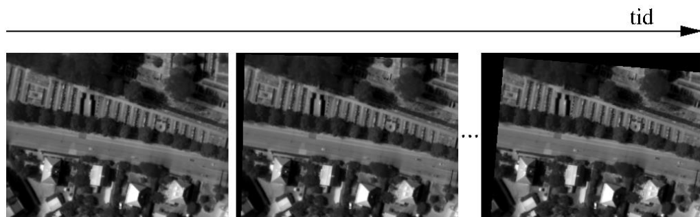
Figur 40. Stabilisering av delsekvens. Genom de skattade homografierna kan bilderna ensas (registreras) till den initiala referensbilden.
