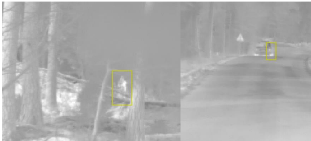
Figur 5. Exempel på falska mål. Ibland kan varma stenar eller träd se ut som människor, detta kan i sin tur resultera i falska mål (vänster). Varma delar på okända objekt kan orsaka falska mål (höger).
