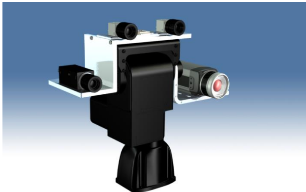
Figur 27. Styrbara sensorsystemet MSP med värmekamera FLIR 655sc, visuell kamera PointGrey ZBR2 monterade på Pan/tilt-vridbord, PTU-D300E ISM från FLIR Motion Control Systems.
