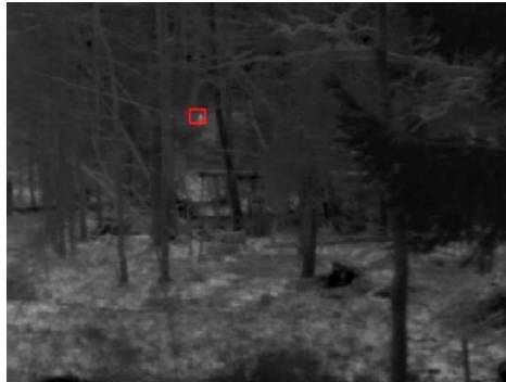
Figur 31. Detektion från styrbar IR-sensor på ett fordon i rörelse.
