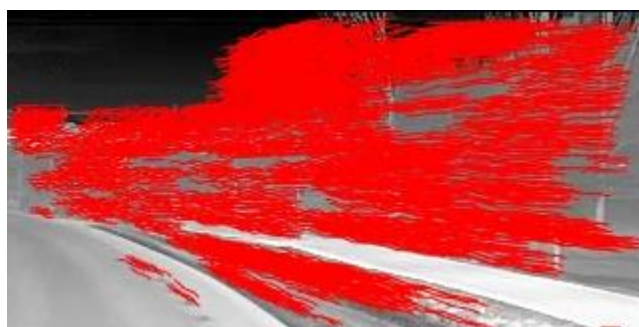
Figur 19. Videoföljning från markfordon. I bilden visas samtliga spår som existerat i minst 5 bilder.
