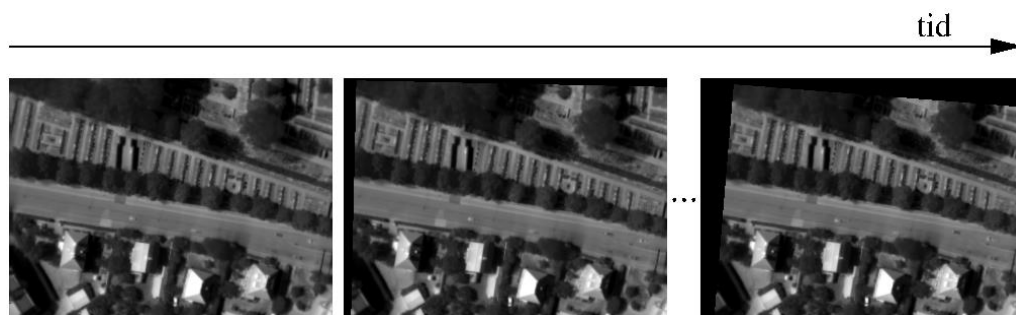
Figur 11. Stabilisering av delsekvens. Genom de skattade homografierna kan bilderna ensas (registreras) till den initiala referensbilden.
