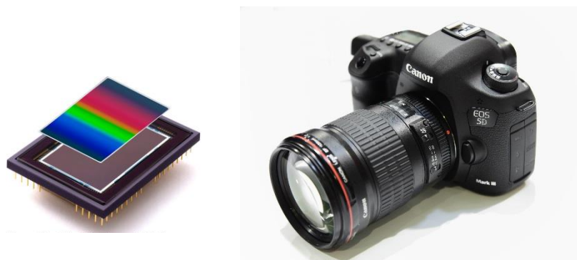
Figur 10: I den hyperspektrala VNIR-kameran är det linjärvariabla filtret monterat ovanpå CMOS-arrayen (vänster) i en vanlig systemkamera (Canon 5D Mark III) (höger).
