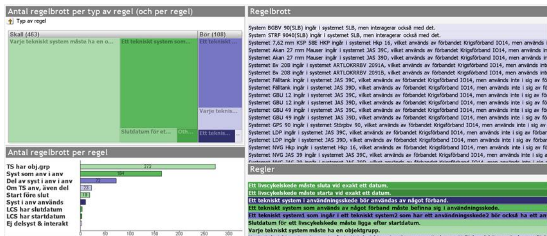
Figur 5: Visuellt interaktivt gränssnitt med lista över regelbrott samt diagram över antal brott per regel. Användaren kan klicka i vyerna för att titta närmare på enskilda regler, regelkategorier, osv.
