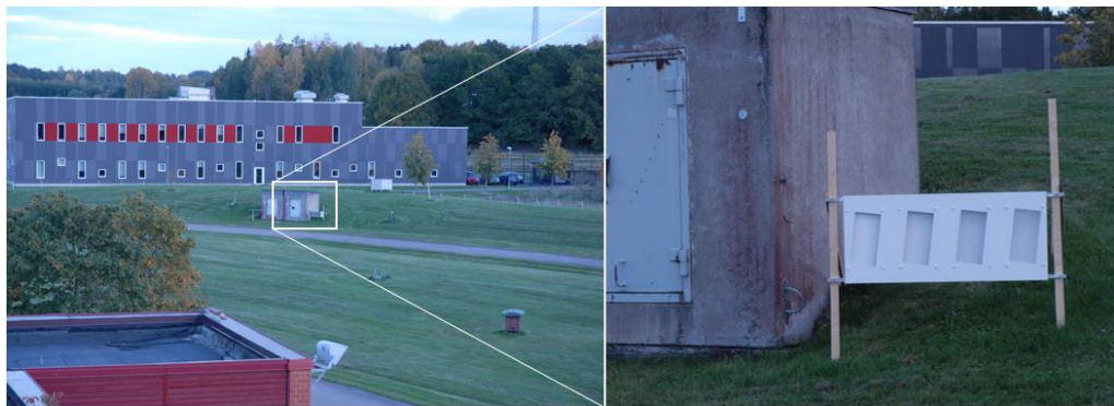
Figur 4. Referenstavlan med bakomliggande grässlätt och betongkassun. Avstånd ca 150 m.
