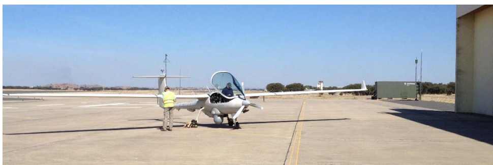
Figur 6-1: UAV av typen Patroller, utvecklad av AIRBEAM partner Sagem. Observera klotet som hänger under flygplanskroppen, vilken innehåller visuella och IR-kamerorna.
