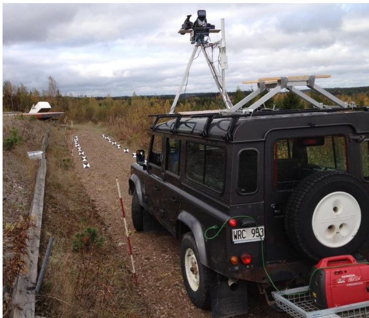
Figur 3: Land Rover med de passiva sensorerna monterade på taket under mätning av referenssträckan.
