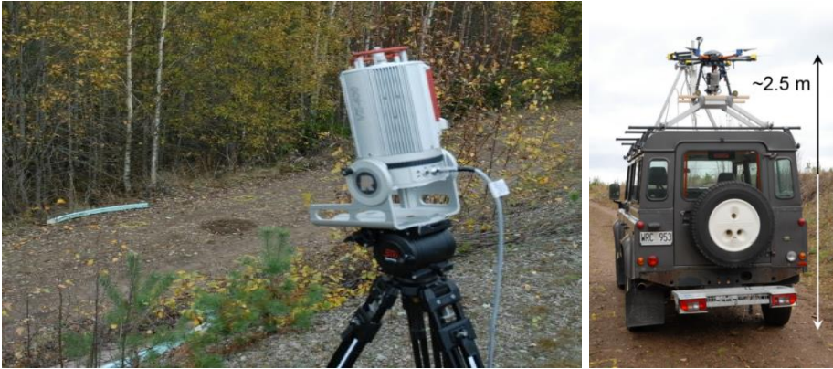
Figur 5. Laserskanner Riegl VZ-400 på stativ och laserskanner Velodyne HLP-32E monterad i en multirotor som i sin tur monterades på taket på en Land Rover.
