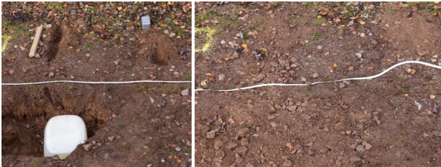
Figur 2: Komplet IED med dieseldunk, batteripack samt tryckplatta under nedgrävning (t.v.) samt efter nedgrävning (t.h.).
