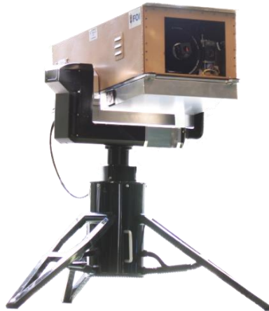
Figur 20. HLIN2-systemet för Ramanspektroskopi.
