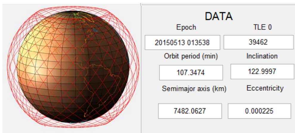
Figur 3.3. Vänster: Banan för TOPAZ-satelliten USA 247 under ett dygn sett från en observatör på jorden. Höger: Banparametrar för USA 247.
