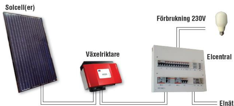
Figur 6. Exempel på ett nätanslutet system. Eventuellt överskott leds ut på elnätet. 22
