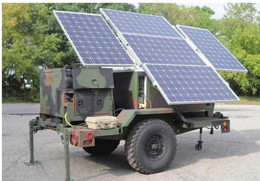
Figur 3. Zerobase transporterbar släpkärre med solpaneler och batterier för energilagring. 12 Anpassningsbar för hybriddrift med vindturbiner och generatorer.
