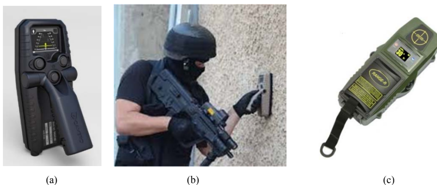
Figur 9. Exempel på nya kommersiella handhållna väggpenetrerande 1D-system. Den vänstra bilden (a) visar Xaver 100 från Camero-Tech [29], bilden i mitten (b) visar exempel på operativ användning av systemet. Bilden till höger (c) visar det handhållna systemet Range-R [30] som enligt den amerikanska tillverkaren CyTerra är det minsta och lättaste av existerande väggpenetrerande system.
