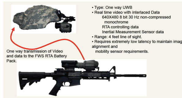
Figur 4.2: Exempel på utveckling av prototyp för hur realtidsvideo kan överföras från vapnets sikten till en HUD, i detta exempel från FWS-I ( Family of Weapon Sights Individual ) till ENVG-III ( Enhanced Night Vision Goggle ) [2].
