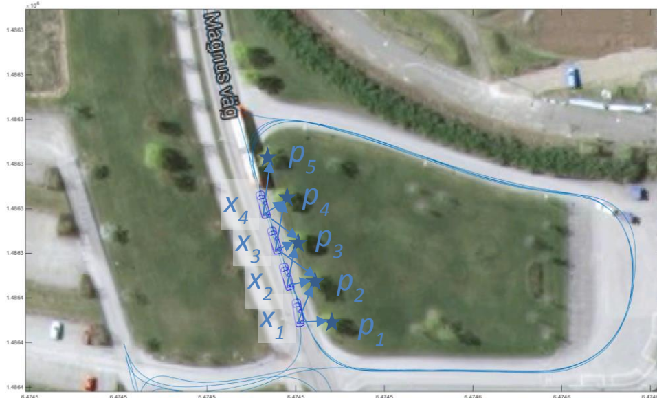
Figur 13. SLAM exempel där ett fordon mäter på fem träd från fyra positioner.
