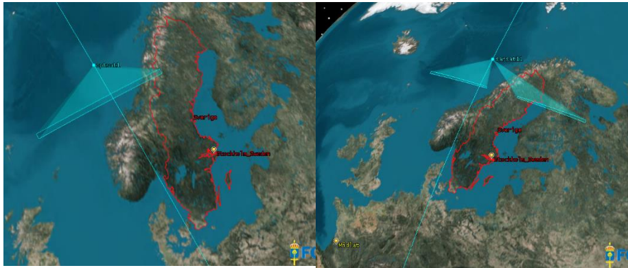
Figur 3. Illustration av betraktningens vinklar för typiska sensorer. Till vänster: optisk sensor med en betraktningens vinkel på 70 grader. Till höger: SAR-sensor som kan avbilda åt antingen höger eller vänster om satelliten och med en sammantagen betraktningens vinkel på 74 grader.
