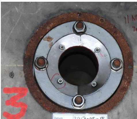
Serie 3 genomföring 3 bortskjuten trycksida efter skott 1.
