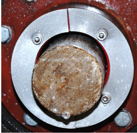
Serie 2 genomföring 17 intryckt tätning trycksida efter skott 2.
