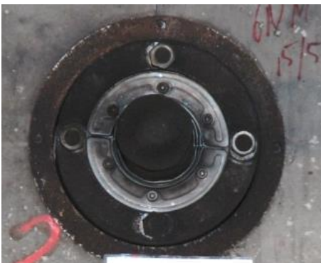
Serie 3 genomföring 2 bortskjuten trycksida efter skott 6.
