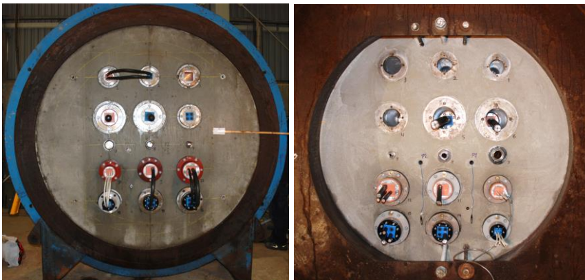
Figur 3.1 Överblick montage tryck- och baksida före belastning provserie 1.
