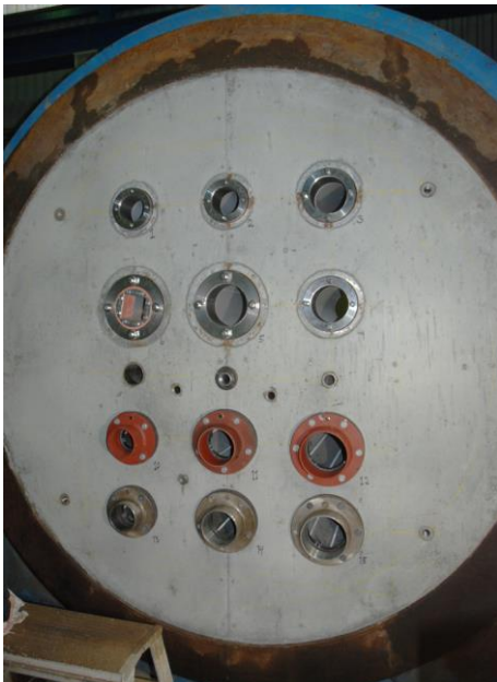
Figur 2.4 Upprest provkropp med adaptrar och ramar monterade.
