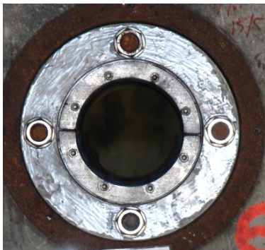
Serie 3 genomföring 6 bortskjuten trycksida efter skott 2.
