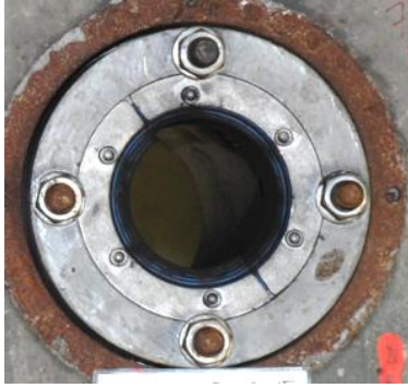
Serie 3 genomföring 4 bortskjuten trycksida efter skott 2.
