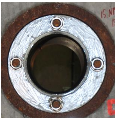
Serie 3 genomföring 5 bortskjuten trycksida efter skott 1.
