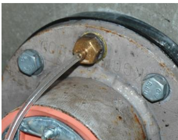
Figur 2.13 Nippel för mätning av tryck i inneslutet hålrum.
