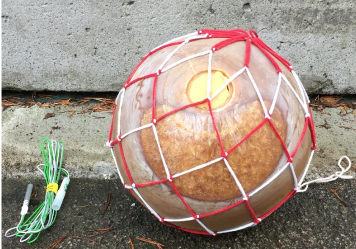
Figur 2.5 Klot av gjuten trotyl med M/46 som booster t.h. El-sprängkapsel t.v.
