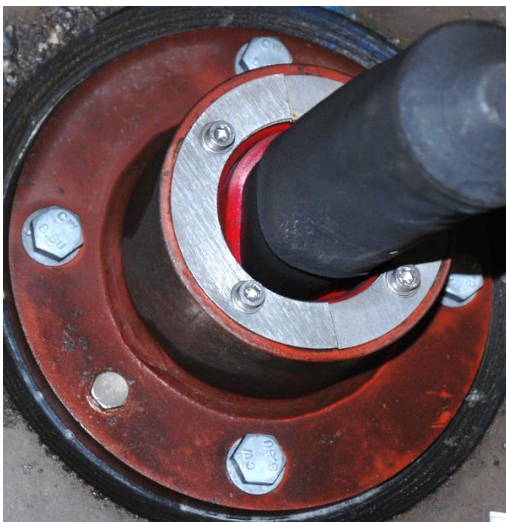
Serie 2 genomföring 16 intryckt tätning trycksida efter skott 4.
