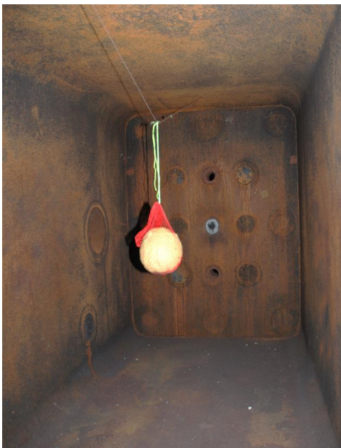
Figur 2.6 Sprängdeg i klotform upphängd i sprängkammare.
