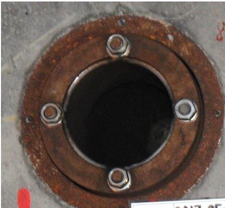
Serie 3 genomföring 1 bortskjuten trycksida efter skott 3.
