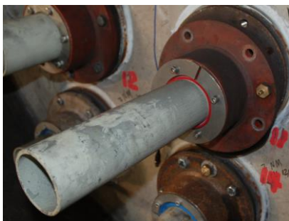
Serie 3 genomföring 11 intryckt rör baksida efter skott 2.
