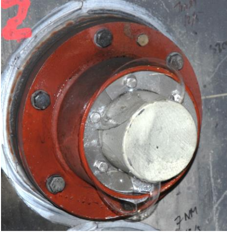
Serie 3 genomföring 12 intryckt tätning trycksida efter skott 2.
