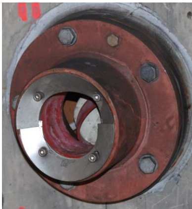
Serie 3 genomföring 11 intryckt rör trycksida efter skott 2.
