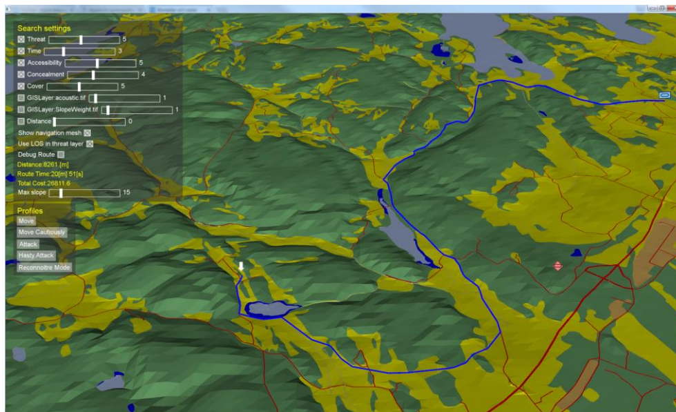
Figur 8. Figuren visar den underliggande datastruktur för vägsökningsalgoritmen – ett s.k. navigation mesh . Färgerna motsvarar olika terrängtyper: vatten (blått), skog (grönt), öppet fält (gult), bebyggelse (orange) samt väg (rött).
