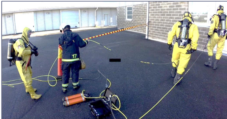
Figur 20. Utrustningen för kemdykning med luftförsörjning genom långslang. Luftdepån kan ses i nedre kanten av bilden med ett luftpaket inkopplat. Två luftpaket samtidigt kan kopplas in för att möjliggöra byte under pågående insats (Foto: Mirko Thorstensson/FOI).
