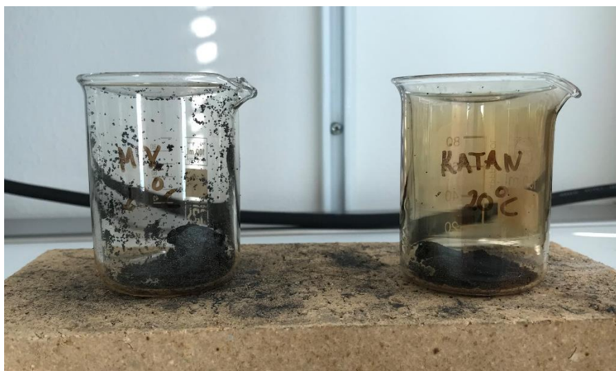
Figur 7. Bägare med MIX och KATAN jonbytarmassa efter torkning vid 240°C.
