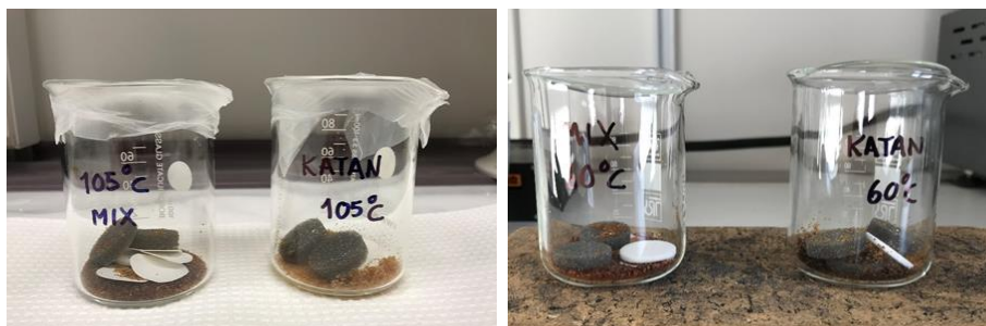
Figur 9. Bågare med MIX och KATAN jonbytarmassa efter torkning vid 105°C samt 60°C.
