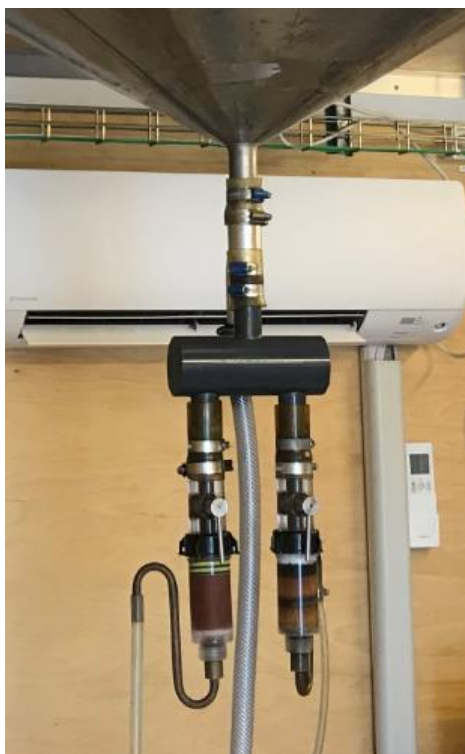
Figur 5. Försökupställning med parallell insamling på de två olika kolonn typerna, KATAN (höger) och MIX (vänster). MIX-kolonnen är uppbyggd av: en skumgummirondell, ca 3 mm filtermassa, en skumgummirondell och sedan ca 50 ml jonbytarmassa av kombinationstyp. KATAN- kolonnen är uppbyggd av: en skumgummirondell, ca 3 mm filtermassa, en skumgummirondell, ca 20 ml anjonbytarmassa, skumgummirondell och sedan ca 20 ml katjonbytarmassa.
