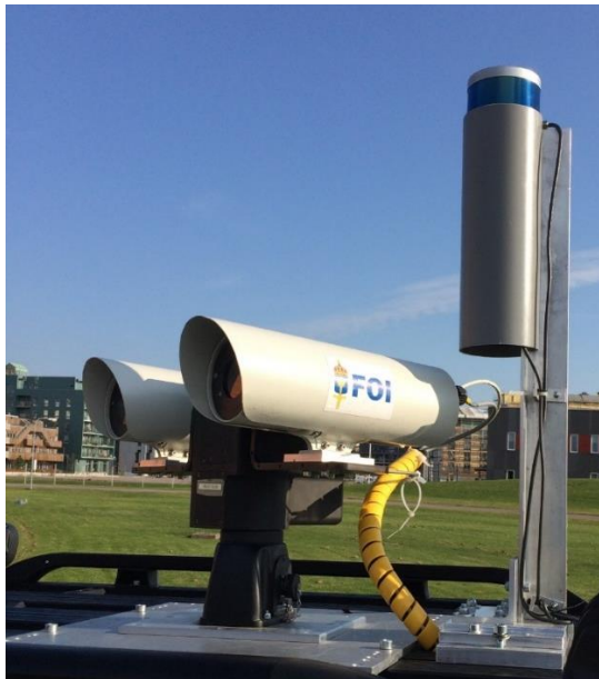
Figur 11. MSP-systemet tillsammans med det LiDAR-baserade positioneringssystemet monterat på ett mätfordon.
