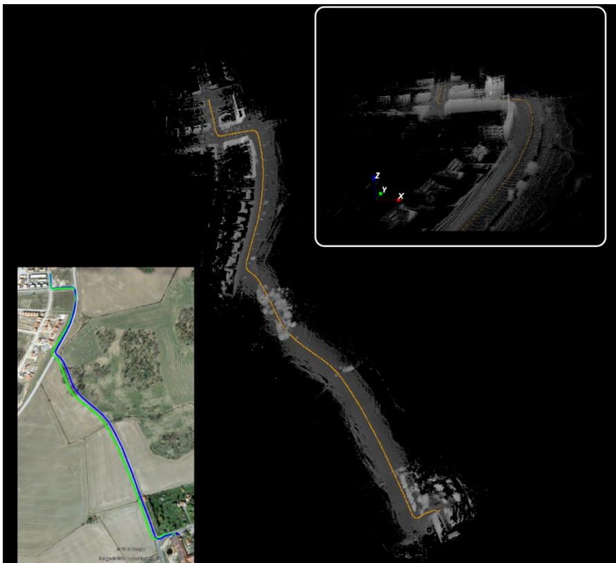
Figur 19. Erhållen 3D-karta från egenpositioneringen i öppen terräng. De gråa punkterna visar LiDAR-sensors uppmätta punkter i 3D, inlagd i det globala koordinatsystemet. Den skattade banan är utritad i orange. Inflikat i det nedre vänstra hörnet ses samma georefererade bana (grön linje) samt uppmätt GPS-data (blå linje) som är överlagrad på ett ortofoto från Google Earth. Längst uppe till höger visas en in-zoomning i 3D-kartan på den övre delen av banan.
