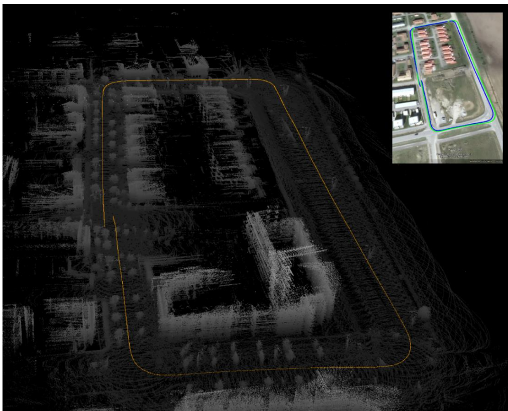
Figur 17. Erhållen 3D-karta från egenpositioneringen i bebyggelse. De grå punkterna visar LiDAR-sensorns uppmätta punkter i 3D, inlagd i det globala koordinatsystemet. Den skattade banan är utritad i orange. Inflikat i det övre högra hörnet är samma georefererade bana (grön linje, motsvarar orange linje i 3D-kartan) samt uppmätta GPS-data (blå linje) som är överlagrad ett ortofoto från Google Earth (observera att ortofotot är något inaktuellt).
