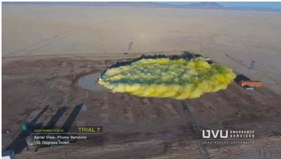
Figur 2. Utsläpp av nästan 9 ton klorgas under ett av försöken inom projektet Jack Rabbit II på Dugway Proving Ground, Utah. Bild med tillstånd av UvU.
