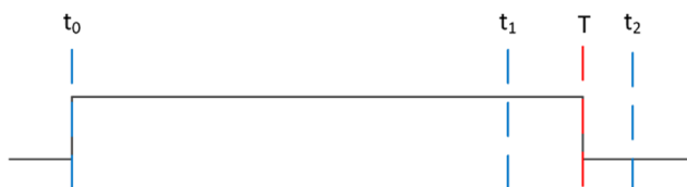
Figur 7. Illustration av en tidstrigger för att starta mätningen för en tidslucka med specifik tid.
