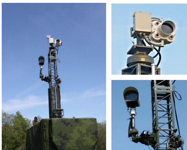
Figur 4: Exempel på mastmonterade kommersiella laserlänkar.
