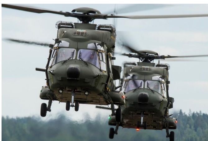
Figur 42: Turbulens orsakad av helikoptern påverkar upplösningen i bilden. Skillnaden syns tydligt på skogsridån under helikoptern i jämförelse med det nedre högra hörnet i bilden. Bild: [Försvarmakten]
