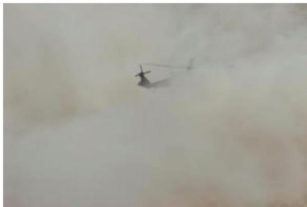
Figur 29: Helikopter 16 utsätts vid landning, framför allt i ökenområden, för en så kallad brownout. Aerosoler i form av små sandpartiklar rivs upp av lufttrycket från rotorbladen och skapar ett dammoln runt helikoptern som begränsar sikten. [SAE] 21
