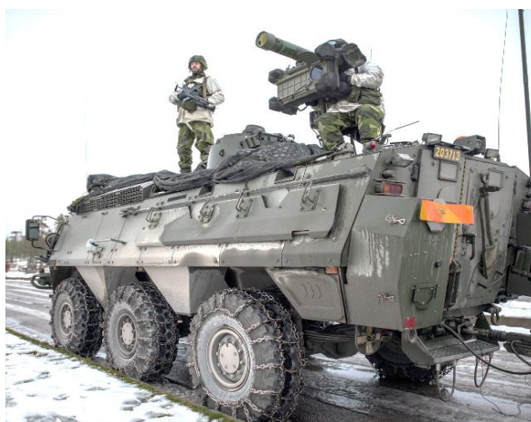
Figur 12: Robot 70 monterad på en pansarterrängvagn under övning. Bild: [Försvarsmakten]
