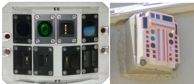
Figur 11: Två exempel på sensorenheter för laservarnare, till vänster Saab Avitronics, LWS 310 för fordon, flyg och fartyg, till höger Elbit, E-laws för fordon och fartyg.
