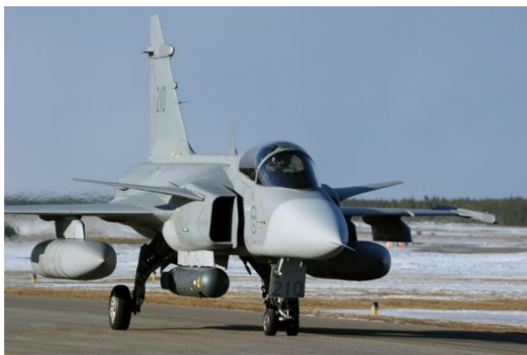
Figur 6: Målutpekningssystem, LDP ("Laser Designator Pod") som används av Gripen-systemet för att fälla bomber som GBU-12 och GBU-49 som är laserstyrda. Bild: [Försvarmakten]
