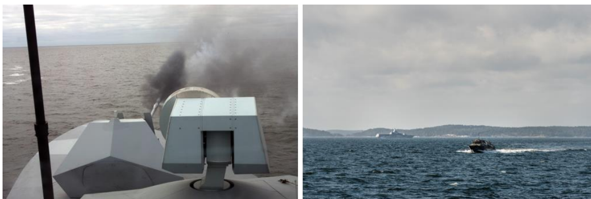
Figur 26: Två typer av aerosoler. Till vänster ses krutrök från eldgivning. Till höger ses havssalt, som i bilden försämrar den visuella sikten mest på längre avstånd med kusten som bakgrund. Bilder: [Försvarsmakten]
