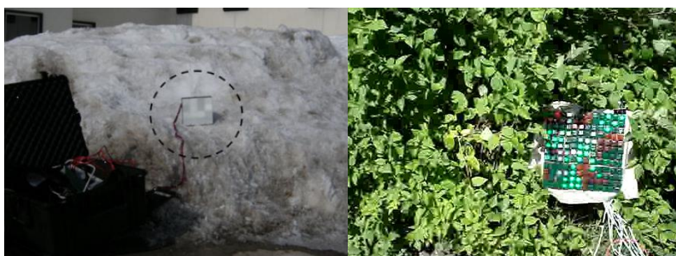
Figur 15. Försök med vit LED från NATO SCI-179 i två olika bakgrunder.
