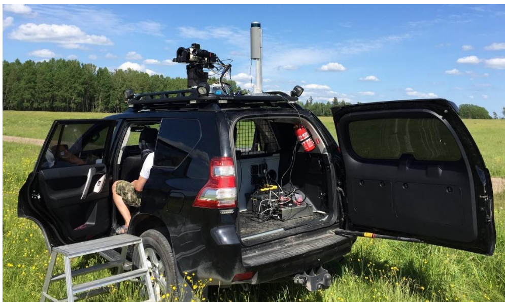
Figur 23. Fotonräknaren har under 2019 anpassats så att mätning kan göras från taket på en bil.
