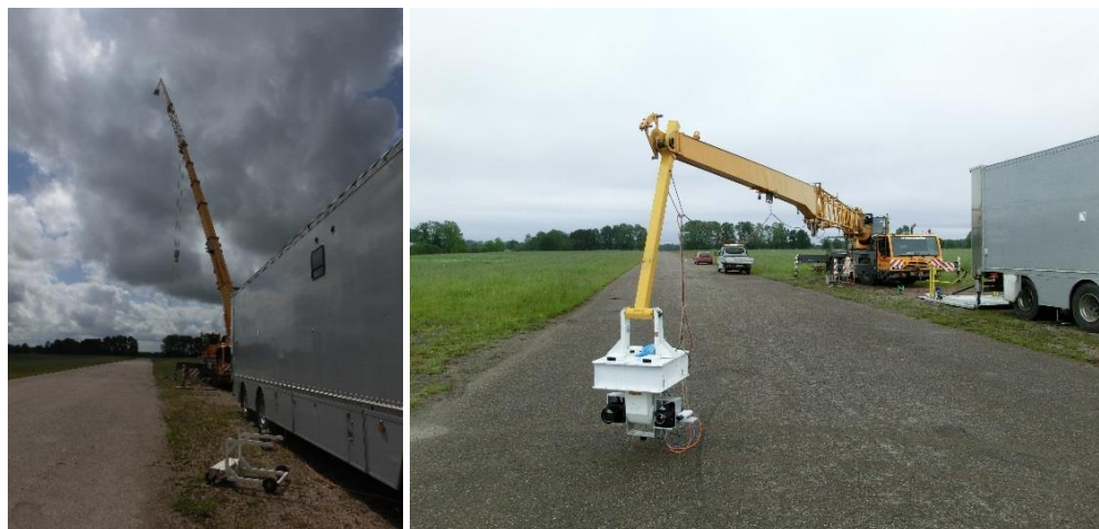
Figur 21. IR-signaturmätning vid provbanan, t.v. med IR-kamerorna i upphöjt läge och t.h. med kranarmen nedsänkt till marken för montering. Hitom kranbilen syns mättrailern.
