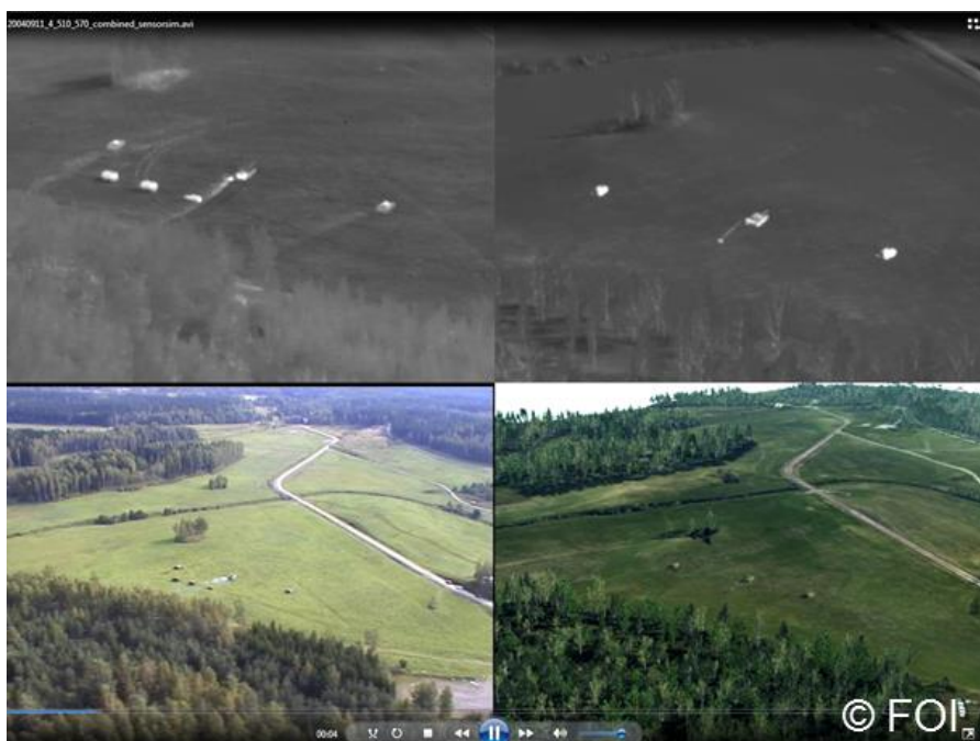
Figur 19. Stillbilder av två MT-LB och en T-72:a (i mitten) från en filmsekvens tagen vid fältförsök (t.v.) och motsvarande simulerade scen (t.h.). De övre bilderna är i LWIR och de nedre i det visuella området.
