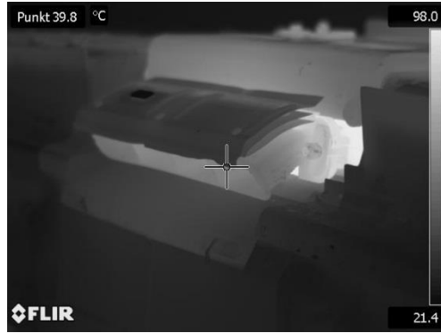
Figur 23. Närbild på T-72:ans avgasutblås inom LWIR. Notera att positionen för temperaturmätningen på avgasutblåset är ovanpå värmeskölden.
