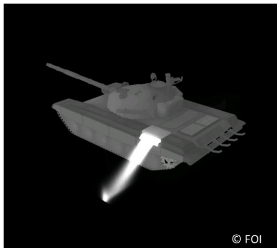
Figur 20. Radiansbild inom MWIR med avgasplymen från en T-72:a genererad med PLUMES och SE-Workbench, där skrovsignaturberäkningen av T-72:an är genererad separat med TAIthermIR.
