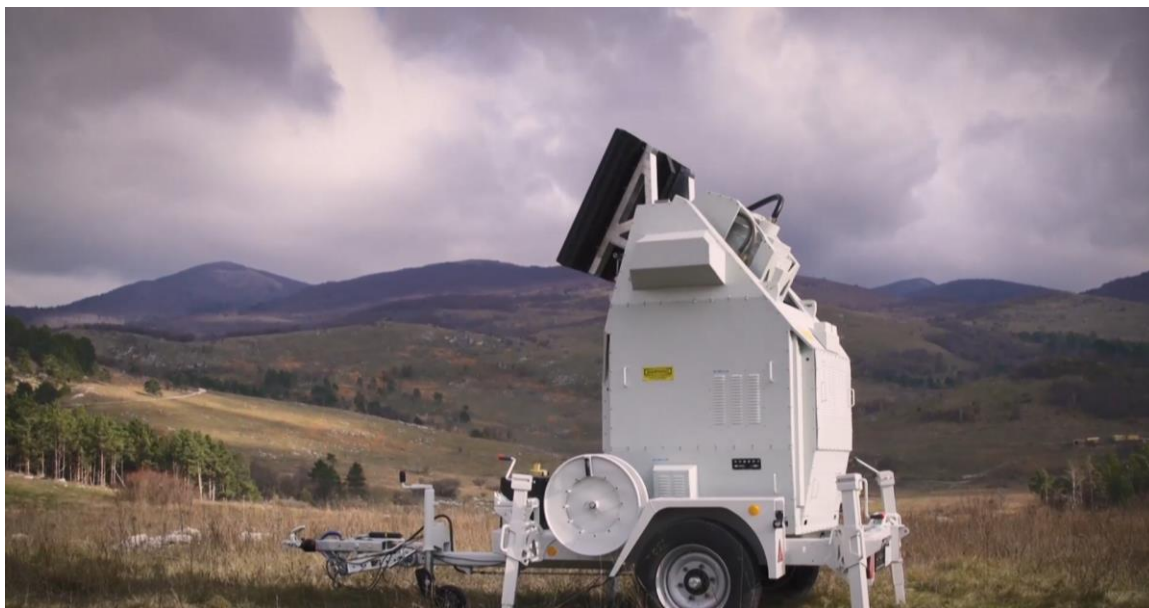
Figur 9. LCMOF L3 500F från brittiska e2v är ett system framtaget för bekämpning av UAV:er. Verkansavstånd uppges variera från 200 m upp till 500 m beroende på UAV-modell. Antennen är av typen 'slotted waveguide' med runt 20 dBi antennförstärkning, pulslängden kan varieras mellan 1 och 4 \mu s och maximal pulsfrekvens är 1000 Hz. Medföljande mjukvara ger operatören möjlighet att förprogrammera olika typer av pulståg och alltså variera pulsfrekvens och pulslängd under pulståget. Magnetron, pulsaggregat och antenn väger cirka 500 kg men monterat på stativet blir totalvikten troligen runt 1500 kg.
