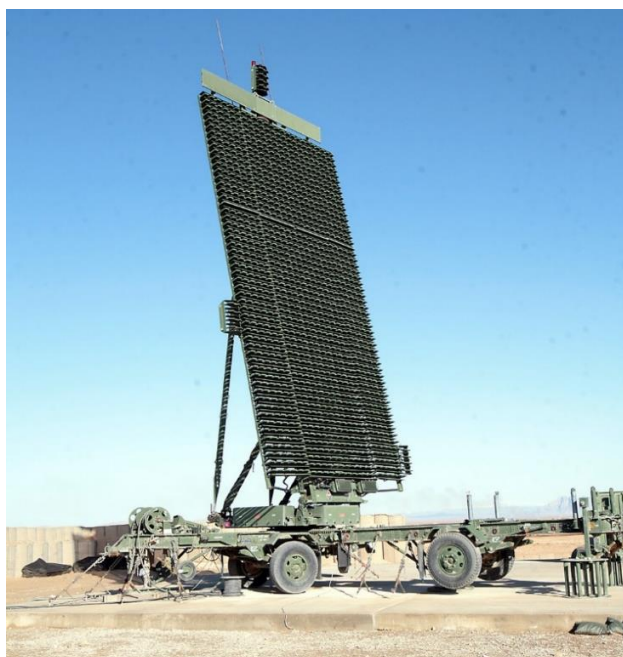
Figur 1. En luftvärnsradar med AESA-teknik från Lockheed Martin. Radarsystemet har en arbetsfrekvens i L-bandet (1-2 GHz) och kan både styra strålen utan att antennen behöver vridas och ändra lobformen mycket hastigt. Bild: Wikimedia commons
