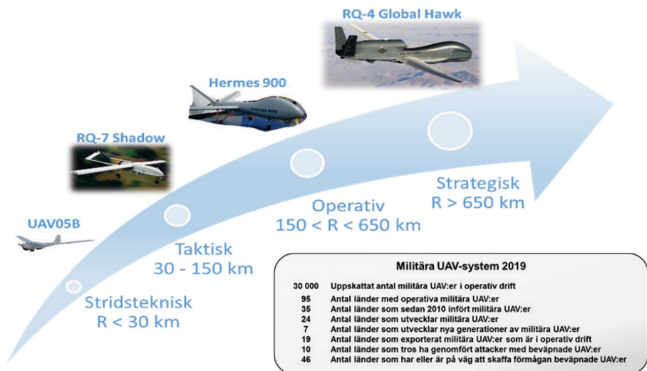
Figur 2.1: Fakta rörande militära UAV-system 2019 sammanställd av "The Center for the Study of the Drone at Bard College" 12 . Exempel på indelning av RPA:er i stridstekniska, taktiska, operativa och strategiska plattformar. Hermes 900 kan nå liknande uthållighet som RQ-4 Global Hawk, drygt 30 timmar, men kategoriseras av Försvarsmakten i klassen operativ UAV [33]. (Foto: Hermes 900 av Matthieu Sontag, CC-BY-SA, övriga public domain)
