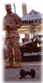
Figur 4.1: Recon Robotics Scout XT är en UGV som liknar Throwbot i storlek och form. (Foto: US Army / Sgt. 1st Class Lisa M. Litchfield / Wikimedia Commons)
