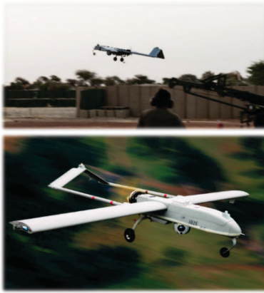
Figur 3.8: Shadow 200 lyfter på sitt första uppdrag i Mali (övre) och RQ-7 Shadow (nedre). Olika versioner av Shadow 200 är operativa i USA, Italien, Australien och Sverige. (Foto: Jonas Svensson, Försvarmakten, och US Army)
