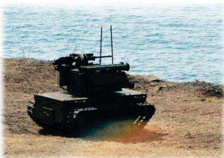
Figur 4.9: Platforma-M. Rysk beväpnad UGV. (Foto: Mil.ru / Wikimedia Commons)
