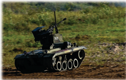
Figur 4.10: Nerekhta. Rysk beväpnad UGV (experimentsystem). (Foto: Mil.ru / Wikimedia Commons)
