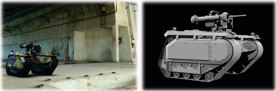
Figur 7.2: 3D-modell av THeMIS-liknande modulär UGV med fjärrstyrd vapenstation med tung kulspruta och AT4. (Illustration: FOI)
