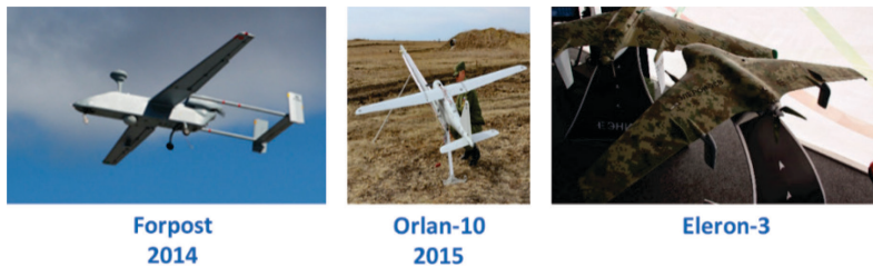
Figur 5.8: Exempel på ryska operativa UAV:er. En taktisk UAV (Forpost) och två stridstekniska UAV:er (Orlan-10 och Eleron-3). (CC Attribution 4.0 och Public domain)
