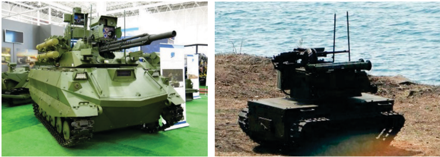
Figur 5.6: Vänster: URAN-9 UGV utrustad med automatkanon, kulspruta och pansarvärnsrobotar. Höger: Den mindre och lättare Platforma-M. (CC attribution 4.0)
