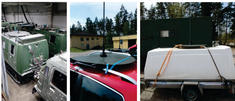
Figur 2. Antenninstallationen monterad på Bv206, på takräcke till personbil, samt på släpkärra med glasfiberkåpa.
