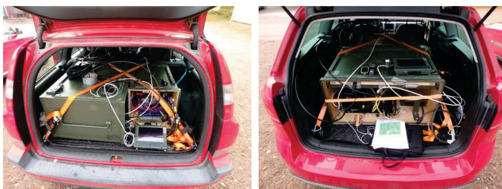
Figur 10. Försöksinstallationerna i två olika modeller av personbil. Beroende på storleken på utrymmet måste lådorna lastas olika för att medge lastföranstring.
