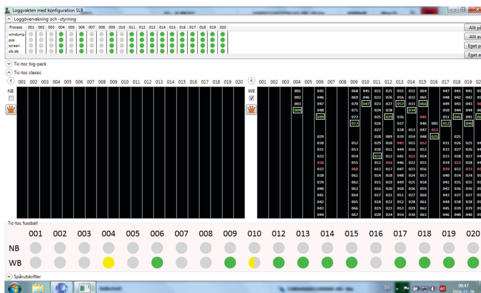
Figur 12. Loggvakten visar status på loggningsapplikationer för alla radionoder som den har förbindelse med, samt möjliggör fjärrstyrd av- och påslagning av respektive loggningsapplikationer (överst). Tre olika vyer, tic-toc big-pack (dold), classic resp. fussball , presenterar dessutom nuläge och historik avseende radioförbindelse på radions olika vågformer: NB och WB, observera att NB är blank i denna bild (mitten, till vänster) eftersom loggvakten var inställd att ej sända någon trafik över den vågformen vid tidpunkten för denna skärmdump. Längs ned finns möjlighet att plocka fram spårutskrift vid behov av fördjupad analys.
