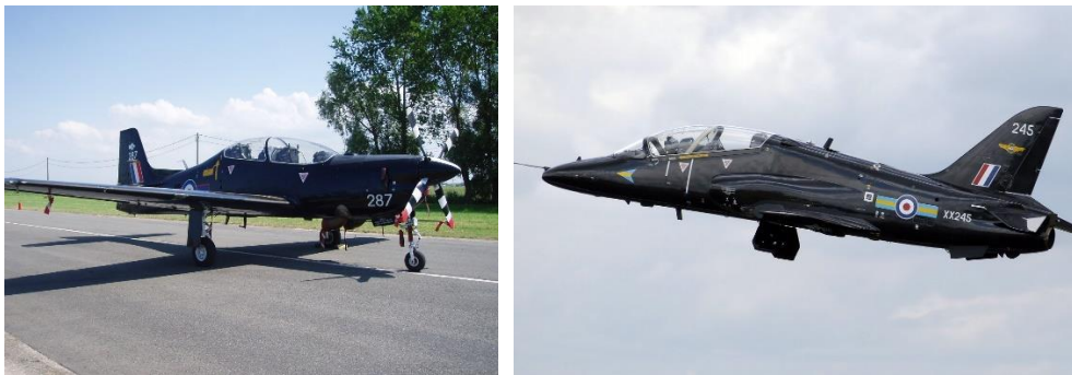
Figur 16. Svartmålade träningsflygplan. Till vänster en Tucano som används av RAF för grundläggande träning (notera röda spetsar på svart-viträndig propeller), till höger en Hawk T1 som flygs av RAF åtminstone till 2030 för mer avancerad träning. (Foto: Adrian Pingstone, Arpingstone, Own work, Public Domain).
