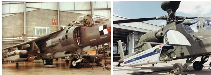
Figur 6.3 – EXINT-kapseln (AVPRO, London, U.K. Ltd) vid prov och försök kopplat till en BAe Sea Harrier och en Boeing AH-64 Apache helikopter (Foto: Think Defence, UK, CC BY-SA 4.0).
