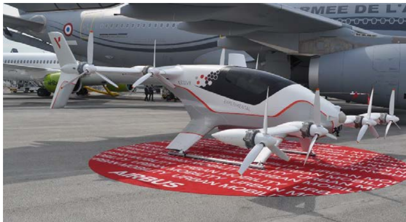
Figur 4.7 – Demonstrator av autonom eVTOL, Airbus Vahana, förevisad i Paris, 2019 (Foto: VFS Staff, CC BY-SA 4.0).
