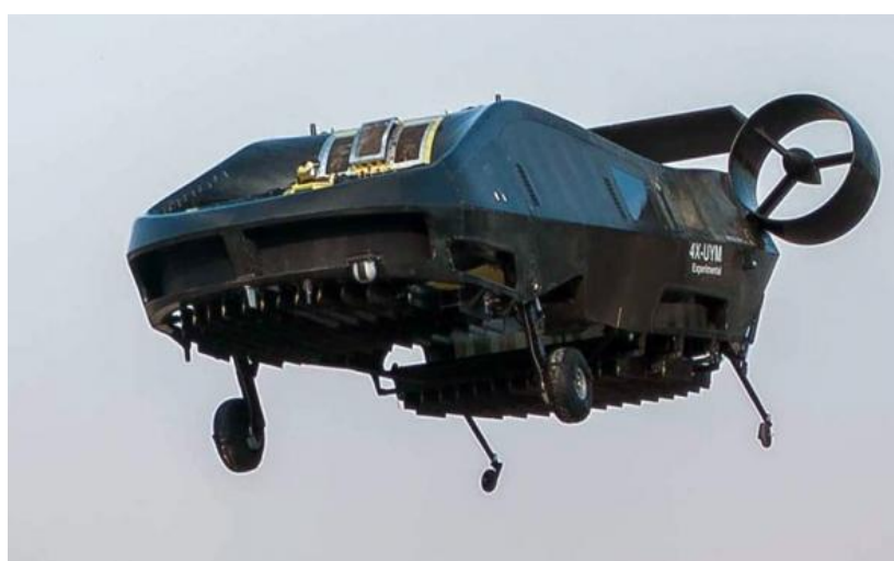
Figur 4.5 – Tidig version av Tactical Robotic’s Cormorant UAV utvecklad för CASEVAC och logistik (Foto: Timur Saban, 2016, CC BY-SA 4.0).
