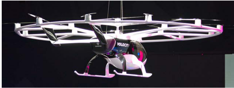
Figur 4.6 – Volocopter’s VoloCity eVTOL UAV utvecklad för Urban Air Mobility tillämpningar (t.ex. flygande taxi). (Foto: Alexander Migl, CC BY-SA 4.0)
