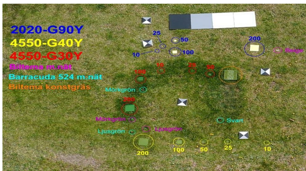
Figur 29. Översiktssbild av scenen och de olika materialen som användes vid datainsamlingen. Bakgrunden utgjordes av en relativt homogen gräsyta med naturliga variationer. Målobjekten som användes var tre typer av målade metallkvadrater, två uppstyckade kamouflagenät samt konstgräs.
