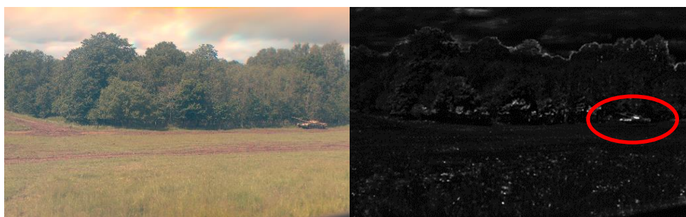
Figur 28. Vänster: En T-72 framför ett skogsbryn. Höger: En anomalibild som skapats med en teknik med ett glidande fönster ( sliding windows ). Anomalibilden visar sannolikhet för anomali, där ljusa pixlar indikerar en hög sannolikhet och mörka pixlar en låg sannolikhet. Gränsområden mellan olika material får högre sannolikhet vilket framträder tydligt i exempelvis gränsområdet mellan himmel och skog. Vid tröskling av anomalivärdena är det enbart militärfordonet som blir kvar.
