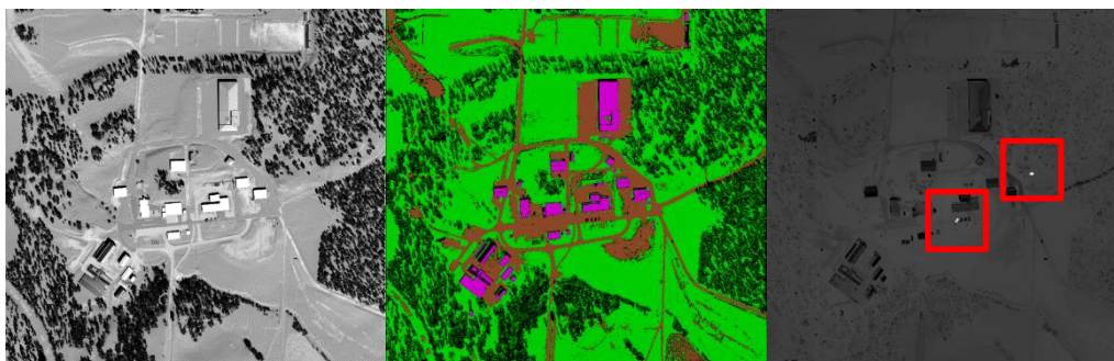
Figur 16. Exempel på materialklassificering och signaturbaserad måldetektion. Vänster: En monokrom bild över en markscen tagen från en flygande plattform. Mitten: Materialklassificering av markscenen utifrån en hyperspektral bild med 100 spektralband med klasserna vägmateriäl (brunt), takplåt (magenta), gräs (ljusgrön), skog (mörkgrönt) och okänt (svart). Höger: Signaturbaserad måldetektion där varje pixels intensitet beskriver hur lika pixeln är ett känt spektrum av en Leopard 2A6. I bilden syns två tydliga detektioner som motsvarar de två utplacerade stridsvagnarna i scenen.
