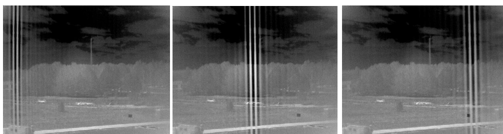
Figur 20. Bildexempel med interferensmönster överlagrat över kamerans bild. Skanning av en scen kan ske genom att svepa kameran synfält över scenen medan interferensmönstret hålls fixt i kameran (exempelvis genom sensorplattformens rörelse eller synfältrotation) eller som i figuren genom att flytta interferensmönstret i sidled över en scen med fixt synfält. [11]
