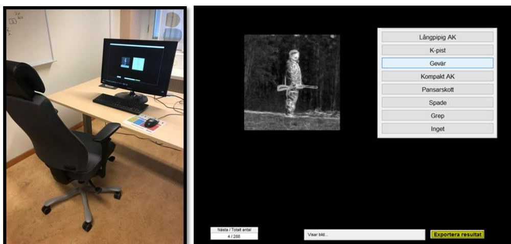
Figur 7. Perceptionstesten utfördes på en PC genom att visa fusionerad bild tillsammans med åtta objektalternativ. Tiden till svar uppmättes och försöksdeltagaren fick även ange konfidensen i sina svar.
