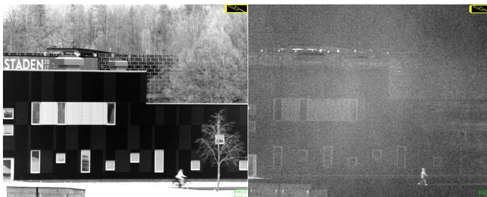
Figur 13. Bilder från den utökade SWIR-kameran HuntIR SWIR (från AIM) genom fönster mot en byggnad på ca 200 meters avstånd i skymning (vänster) respektive i nattmörker (höger). Notera den detekterade värmestrålningen från fotgängaren, taget genom vanligt fönsterglas. Bildtakten var 50 Hz.
