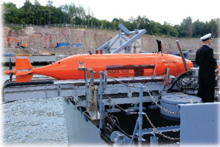
Figur 5.4: En Kongsberg Hugin 1000, som är utrustad med en HiSAS 1030, ombord på ett av finska marinens fartyg i Katanpääklassen, 2014 (foto: MKFI 103 , public domain).
