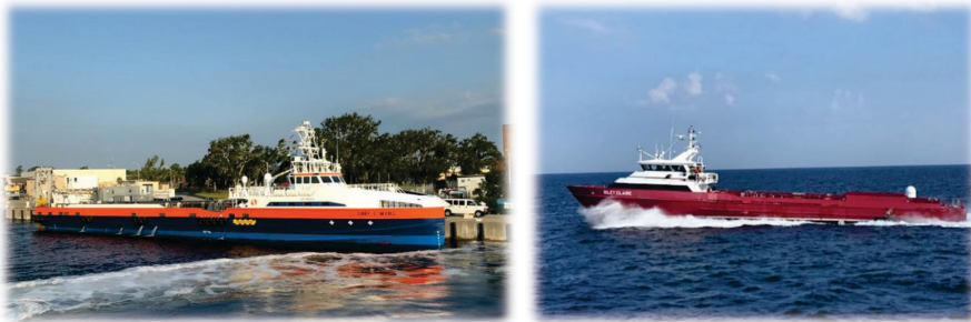
Figur 4.7: Två prototypfarkoster som utvecklats av OSD SCO inom Ghost Fleet Overload. Dessa prototyper kommer användas av US Navy vid experimentering i samband med utvecklingen av Large USV (foto: US Navy, public domain).
