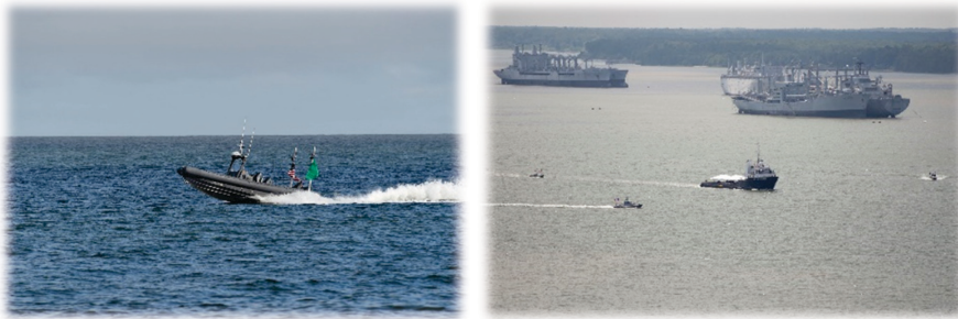
Figur 6.2: Office of Naval Research (ONR) genomför demonstration med svärm av olika USV:er. Vänster: Exempel på en RIB-baserad USV (en av flera varianter) som användes vid demonstrationen (foto: John F. Williams, US Navy, CC BY 2.0). Höger: Flera USV:er manövrerar runt ett fartyg där uppdraget är att skydda detta mot hot från andra ytfartyg (foto: Mass Communication Specialist 2nd Class John P. Kotara, US Navy, CC BY 2.0).
