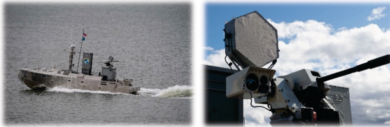
Figur 4.5: Vänster: Utvecklingsversion av Common USV 77 vid övning utanför Naval Station Norfolk. Höger: RCWS på Common USV. Common USV införs nu i US Navy för användning inom MCM på US Navy LCS (foto: Mass Communication Specialist 3 rd Class Rebekah M. Rinckey, U.S. Navy, public domain).
