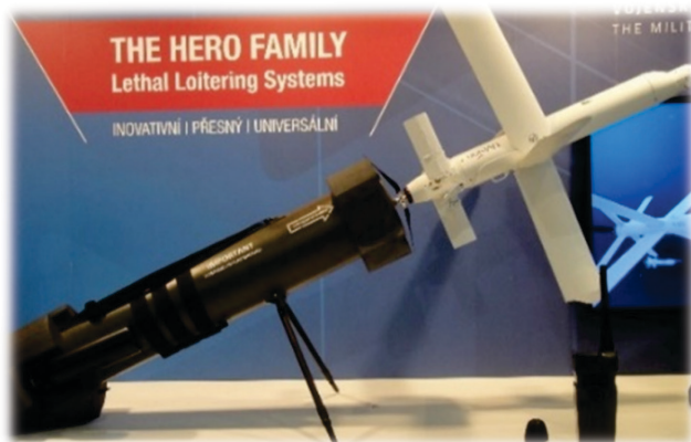
Figur 3.11: Uvision Hero-30. Patrullrobot med utvikbara vingar som skjuts ut från en tub (foto: Reise 56 , CC BY-SA 4.0).
