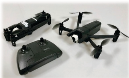
Figur 3.2: Parrot Anafi med visuell kamera och infällda rotorarmar och termisk kamera med rotorarmar utfällda (foto: FOI).
