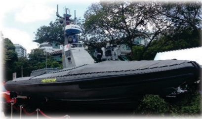
Figur 4.4: Tidig version av Protector USV utrustad med en mini-Typhoon RWS. Protector är en Israelisk USV som har använts operativt av bland annat Israel, Singapore och Mexiko (foto: Smuconlaw 68 , CC BY-SA 3.0).
