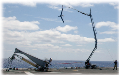
Figur 3.5: ScanEagle katapult och fångstanordning (USS Saipan, 2006). ScanEagle 2 används operativt bland annat av Australien, USA och Kanada (foto: Mass Communication Specialist Seaman Patrick W. Mullen III, US Navy, public domain).
