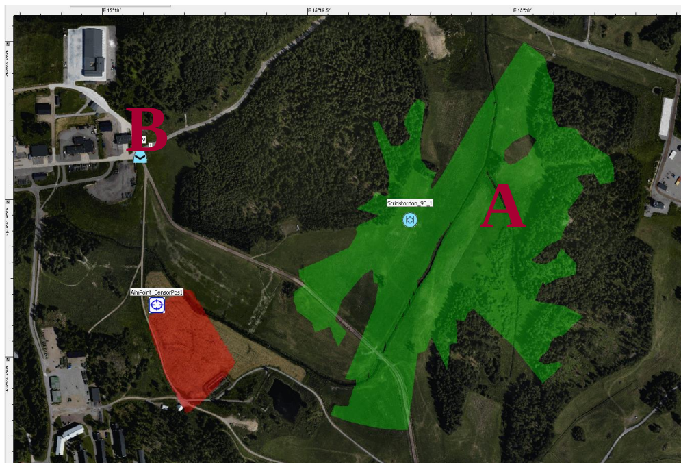
Figur 26 Karta över Kvarn samt visualiserad terrängdata i NetScene. Synfältet runt om punkten A på 1 m höjd över marknivån (grönt). Det projicerade synfältet från en sensor monterad i en UAV placerad vid punkten B på 300 m höjd över marken (rött).
